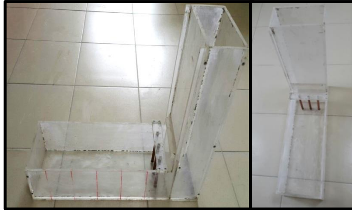
Şekil 3. 7. Şeffaf L-kutusu deney düzeneği
