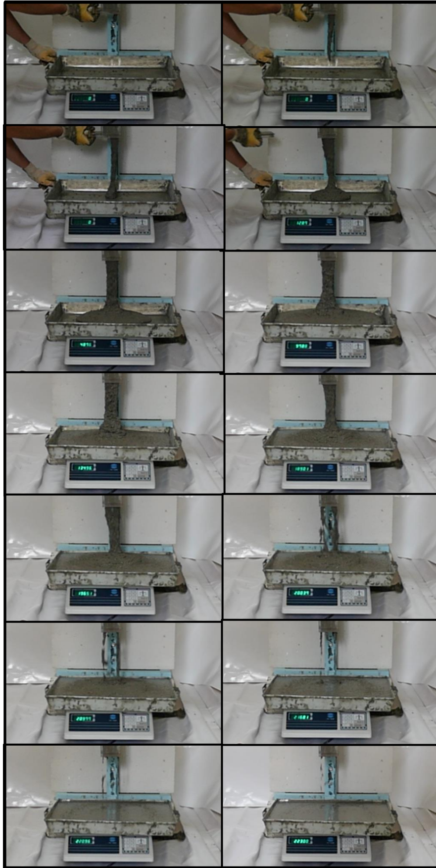
Şekil 4. 1. V-hunisi deneyi yavaş çekim ekran görüntüleri.
