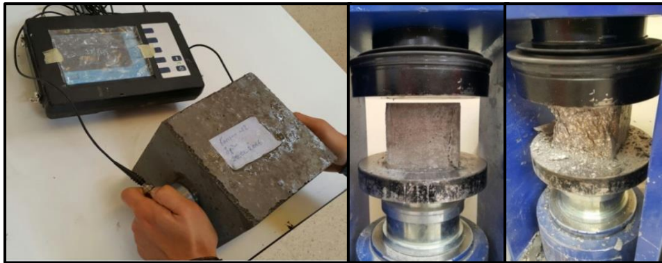
Şekil 4. 14. KYB sertleşmiş beton deneyleri.
