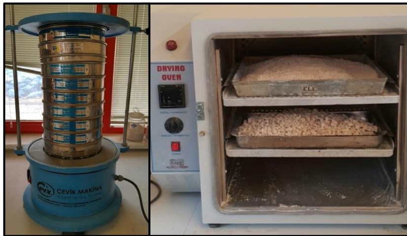
Şekil 3. 2. Granülometri için kullanılan elek takımları ve etüv.
