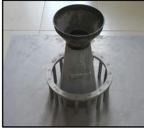
Şekil 3. 4. J- halkası deney düzeneği
