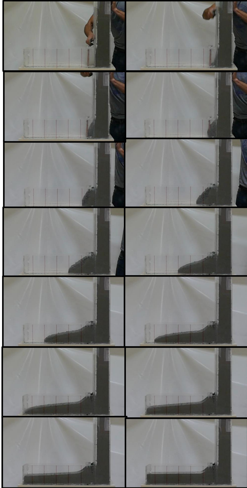
Şekil 4. 2. L-kutusu deneyi yavaş çekim ekran görüntüleri.
