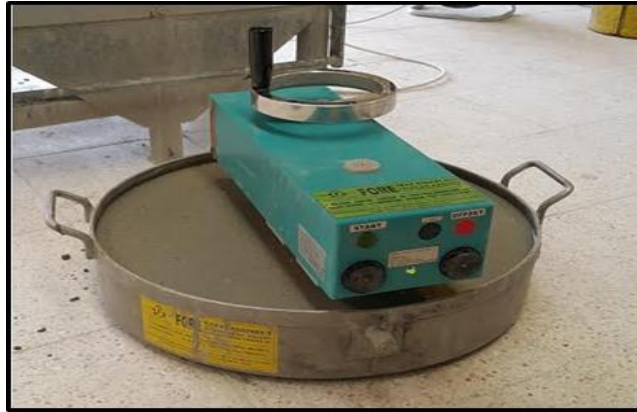
Şekil 3. 8. Taze beton reometresi.
