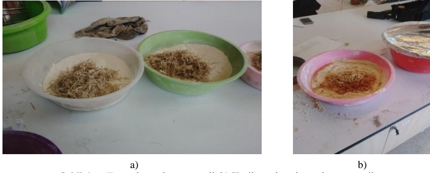
Şekil 4. a) Toz atık tavuk ty ve silt b) Kesilmemiş atık tavuk ty ve silt
