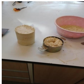
Şekil 5. Kompaksiyon sonrası atık tavuk ty ve silt karışım ın kompaksiyon kalıbından ıkarılması
