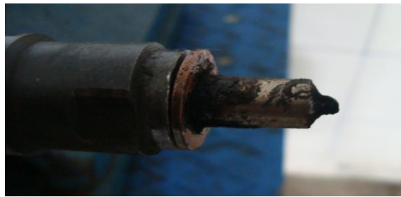
Şekil 5.2. 110 saatlik çalıştırılma sonucu çıkan enjektör ucu.
