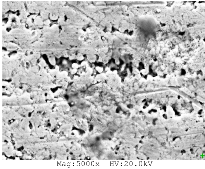
Şekil 4.10. Dizel yakıt ile çalıştırılan enjektör kanalındaki EDX analizi yapılan yüzey.
