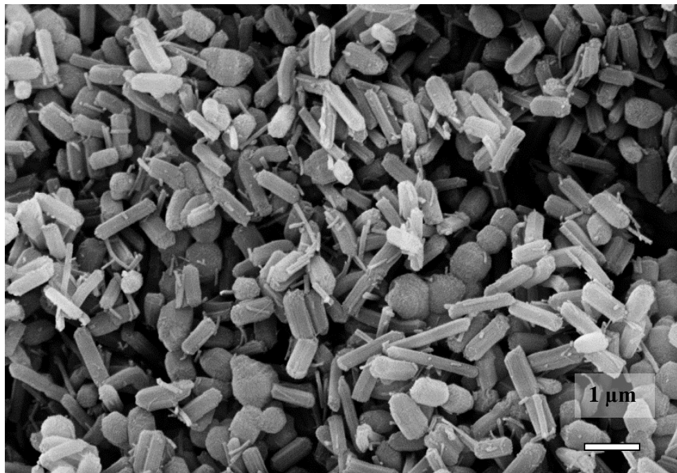
Şekil 9.24. SBA-15 katalizörün SEM görüntüsü.
