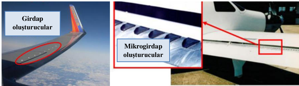
Şekil 2.16. Pasif Akış Kontrol Yöntemlerinin Uygulamaları
