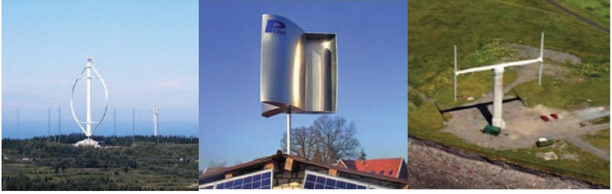
Şekil 2.5. Soldan Sağa; Darrius, Savonius, H-Tipi DERT
