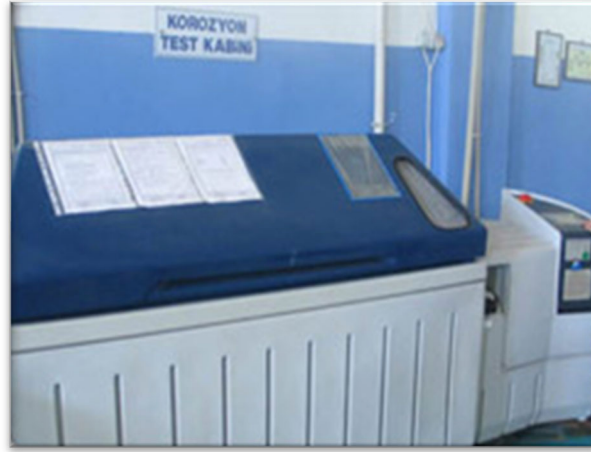
Şekil 6.5. Tuz sisi test cihazı
