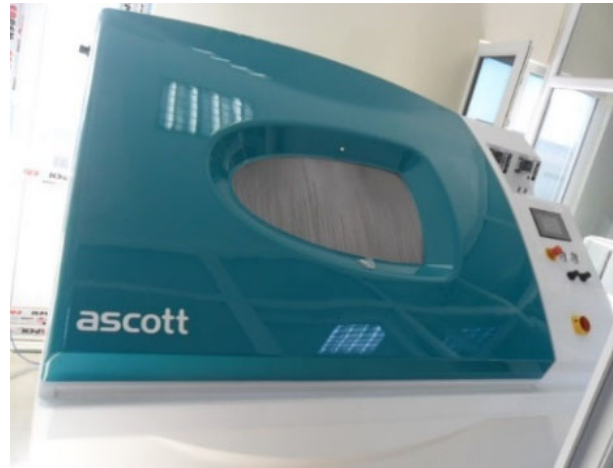
Şekil 6.7. Çevrimsel korozyon test kabini
