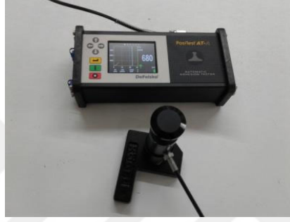
Şekil 6.3. Pull-Off adhezyon test cihazı
