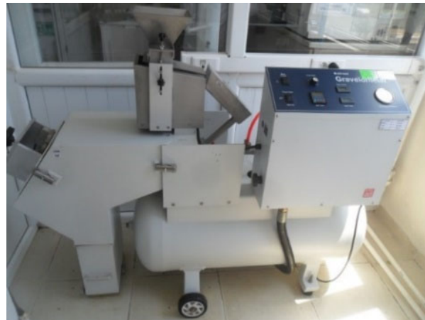
Şekil 6.6. Taş çarpma test cihazı
