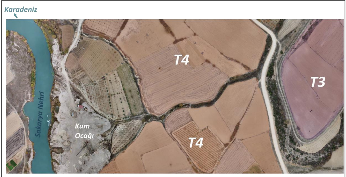
Şekil 3.10. Gemiciköy Çevresindeki Seki Sistemleri Üzerinde (13,9 Hektarlık Bir Alan-T3 ve T4) DJI Mavic Mini İHA Modeli Kullanılması Sonucunda Elde Edilen Yüksek Çözünürlüklü Sayısal Yüzey Modeli (3,29 cm/pix) ve Ortomozaik Görüntüsü.
