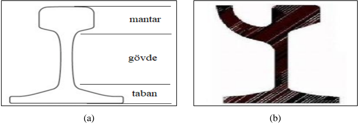
Şekil 2.1. (a) Vinyol profilli ray ve (b) Oluk profilli ray
