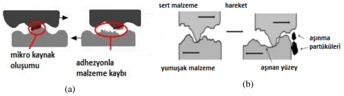
Şekil 2.12. (a) Adhesif aşınma, (b) abrazif aşınma mekanizmaları
