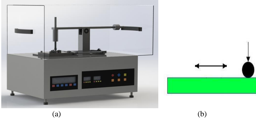
Şekil 6.6. (a) Bilye-disk deney düzeneğine sahip ileri-geri hareket eden aşınma deney cihazının genel görüntüsü ve (b) bilye-disk düzeneğinin şematik gösterimi
