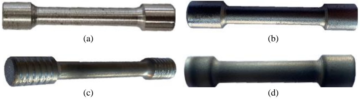
Şekil 6.5. Çekme deneyi numunelerinin görüntüleri; (a) işlem görmemiş çelik, (b) BD işlem görmüş çelik, (c) PN işlem görmüş çelik ve (d) BD+PN işlem görmüş çelik
