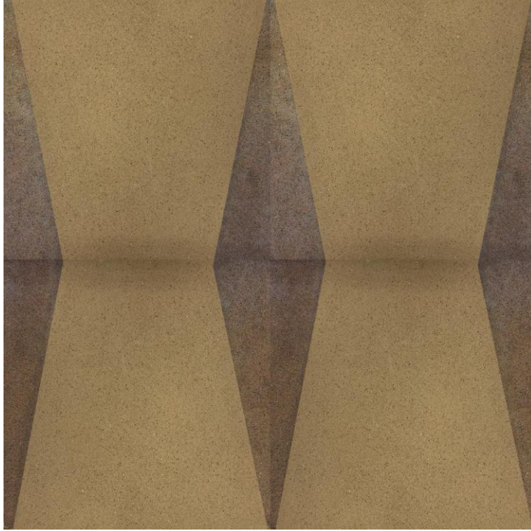
Görsel 4.4. FSDÇR1-GSDÇR2-KSDÇR1 Duvar Karosu Sırlı Örneği, 30x30 cm, 1120-1200°C.
