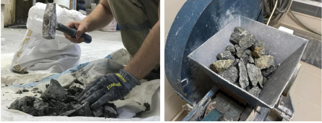
Görsel 2.7. Hammaddeleri Çekiçle Küçültme ve Çeneli Kırıcıda Kırma İşlemleri.
