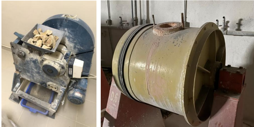
Görsel 2.8. Hammaddeler Çeneli Kırıcıda Ön Kırma İşlemi ve Bilyeli Değirmende Kuru Öğütme İşlemi.
