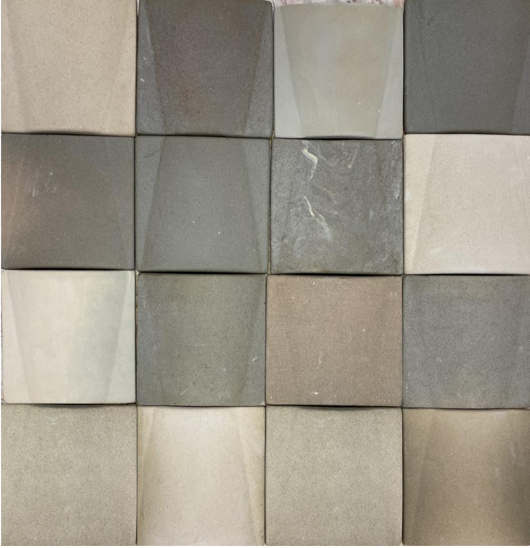
Görsel 4.2. FSDÇR1-GSDÇR2- GSDÇR2-KSDÇR1 Duvar Karosu Örneđi, 60x60cm, 1050-1120-1200°C.
