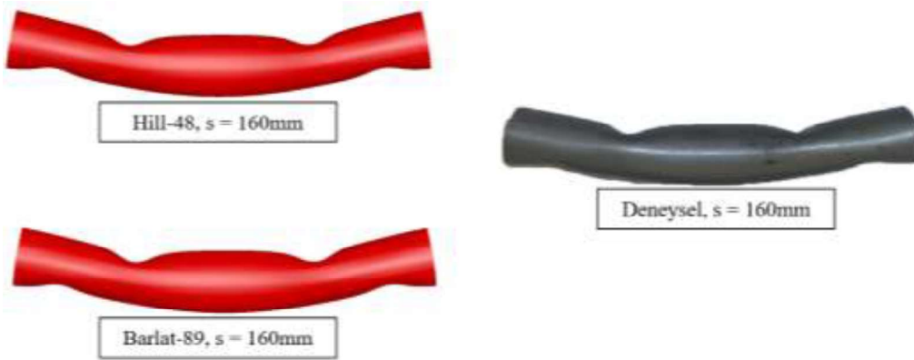
Şekil 12. Dört nokta eğme için elde edilen deforme olmuş geometrilerin deneysel ve sonlu elemanlar yöntemi ile karşılaştırılması
