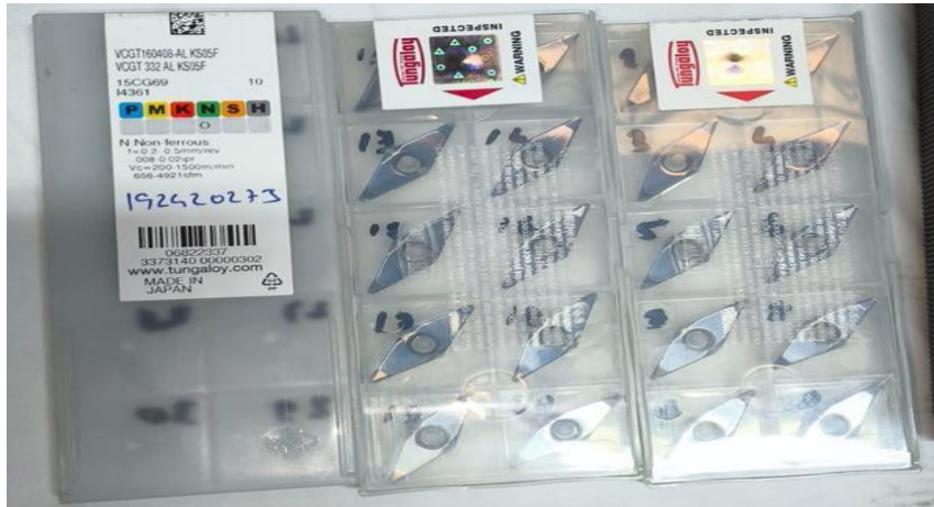
Şekil 6.4. Tungaloy VCGT 332 Al Finish Kesici Uçları
