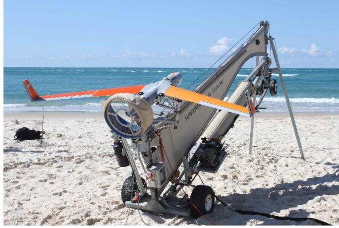
Şekil 4. Mekanik fırlatıcı yapısı
