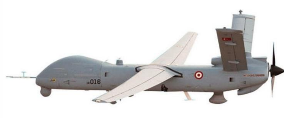
Şekil 1.8. Turba Şaft Dizel Motorlu Yüksek İrtifa İHA (ANKA)
