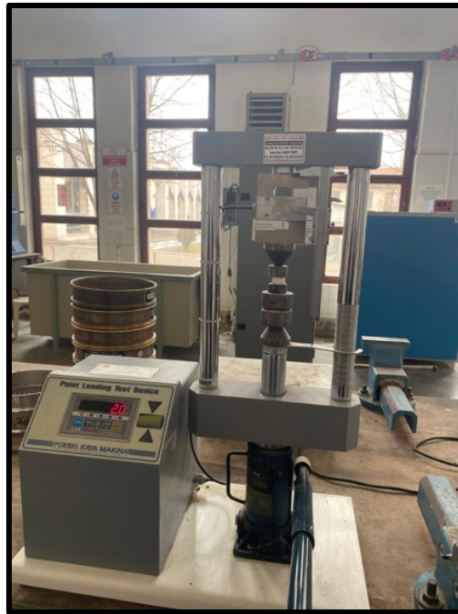
Şekil 3.9. Basınç dayanımı deney düzeneği
