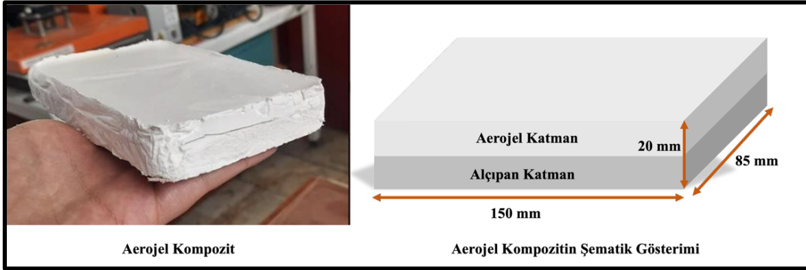
Şekil 3.16. LWA-Kompozit örneği ve şematik gösterimi.
