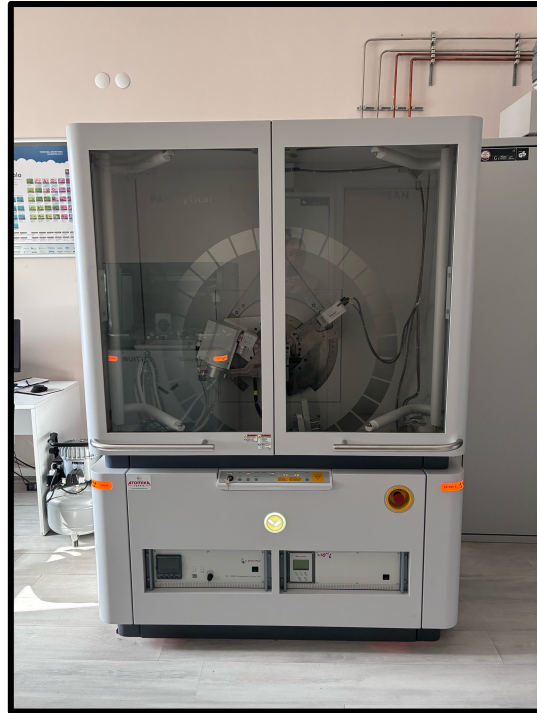
Şekil 3.4. Kristal yapı tespitinde kullanılan XRD cihazı.
