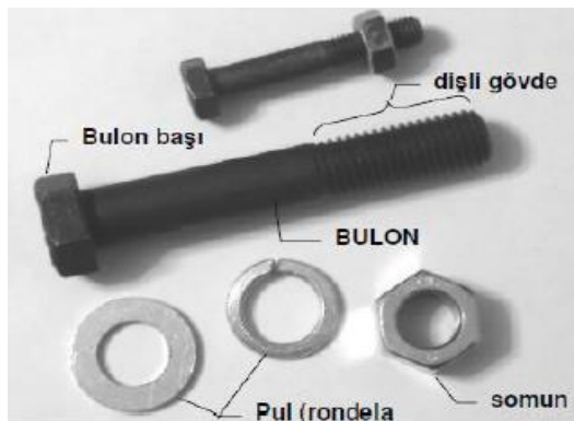
Şekil 6.8. Bulon ve birleşenleri(Ateş, 2011)
