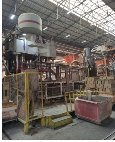
Şekil 5.9. Hidrolik Pres ( 1500 \text{ kg/cm}^2 )
