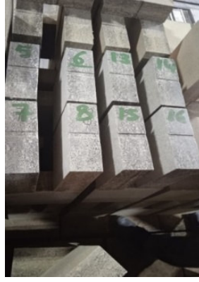
Şekil 5.16. Tanımlanan Kompozisyonların Fırın Arabasındaki Görünümü
