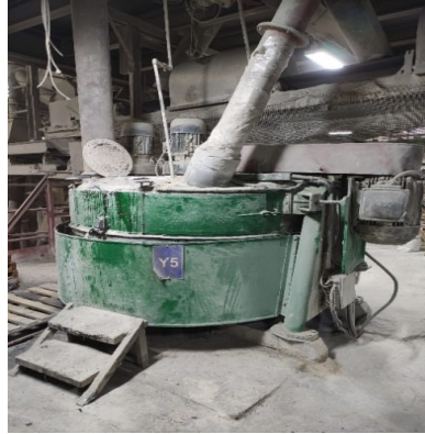
Şekil 5. 8. Karıştırıcı (Yaklaşık 1250 kg Kapasiteli)
