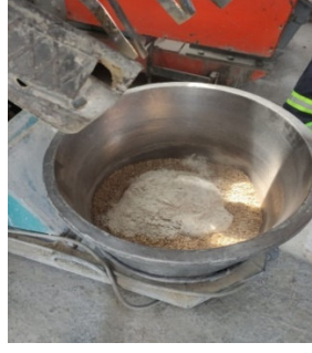
Şekil 5.13. Laboratuvar Tipi Mikserde İri, Toz ve Bağlayıcının Birleşmesi
