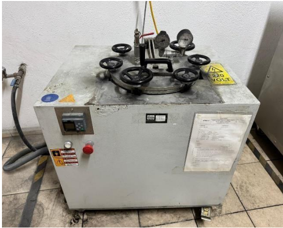
Şekil 6.12. Porozite Ölçüm Test Cihazı
