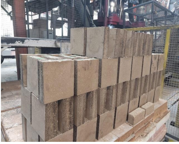
Şekil 6.8. Üretilen Tuğlaların Şekillendirme Sonrası Fırın Arabasındaki Görünümü
