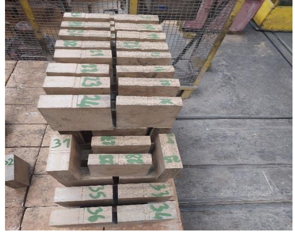
Şekil 6.8. Üretilen Tuğlaların Şekillendirme Sonrası Fırın Arabasındaki Görünümü
