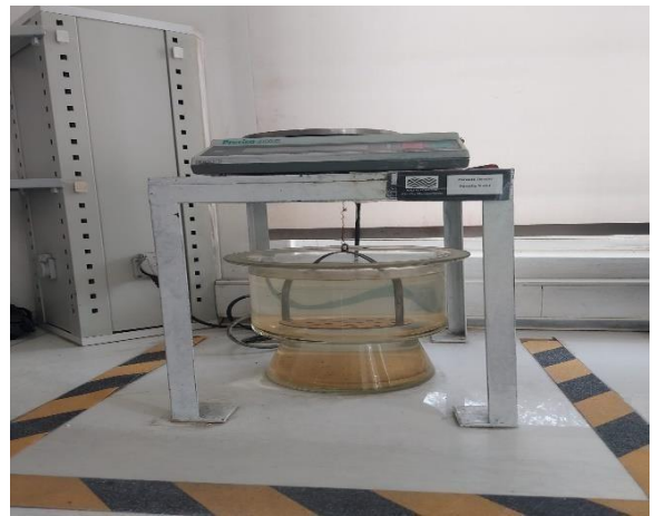
Şekil 6.13. Porozite Tartım Sehpası
