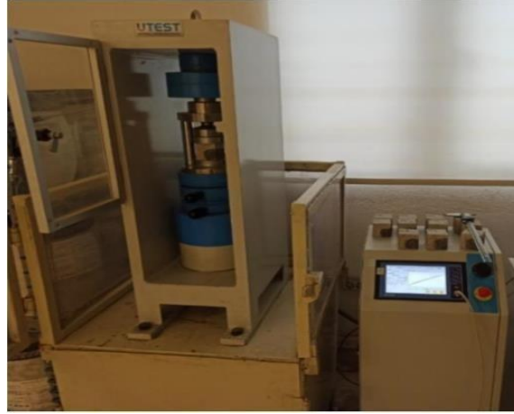
Şekil 6.14. Soğukta Basma Mukavemet Cihazı
