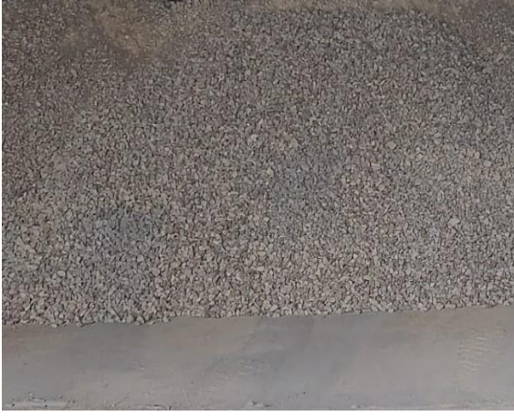
Şekil 6.2. Deniz Suyu Sinter Manyeziti
