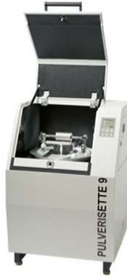
Şekil 7.3. Numunelerin öğütülmesinde kullanılan Fritsch Pulverisette 9 halkalı değirmen
