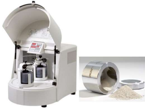
Şekil 7.5. Deneylerde kullanılan gezegensel değirmen ve çelik hazne
