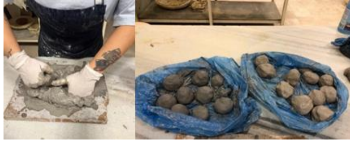
Resim 7. Çamur hazırlama aşaması
