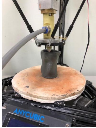
Resim 9. Üç boyutlu yazıcı ile şekillendirme aşaması
