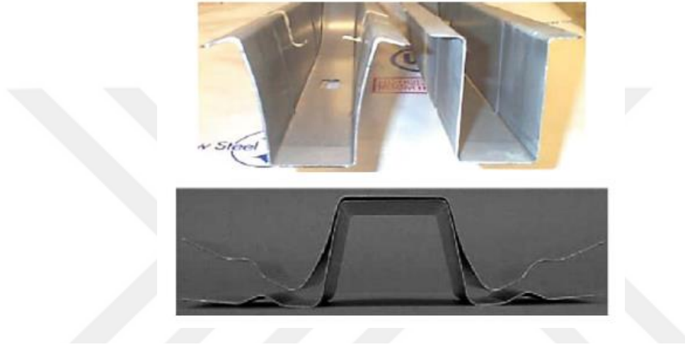
Şekil 2.8. Sac Metal Şekillendirmede Geri Esneme Hatası Kaynak: (Hsu vd, 2002:362)
