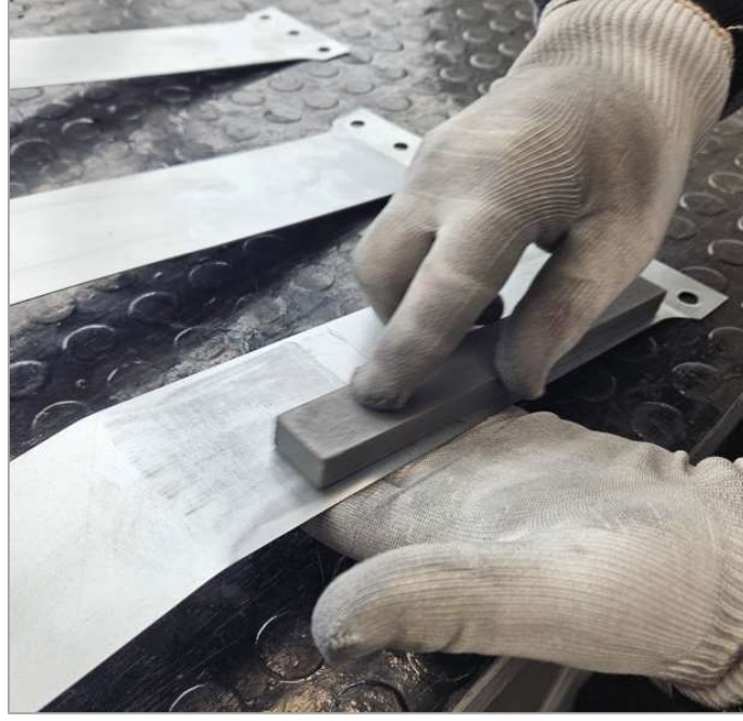
Şekil 4.5. Deformasyon tespiti için taş sürme işlemi
