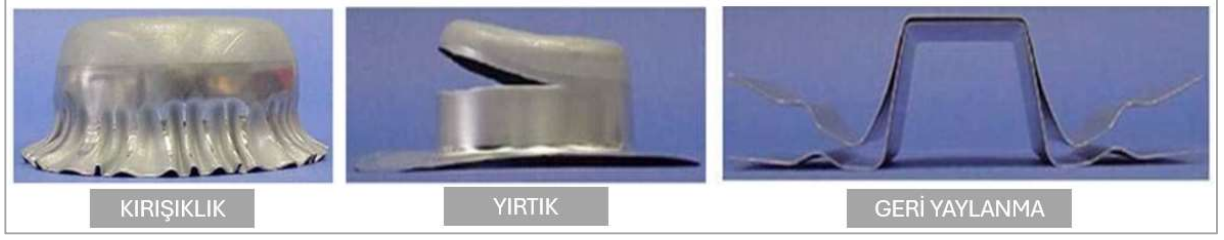
Şekil 1.5. Sac şekillendirme de deformasyon örnekleri
