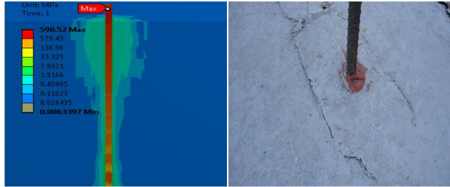
Şekil 6.11. M1 malzemesi, 20 mm çaplı 20Φ derinlikli ankraj modeli.
