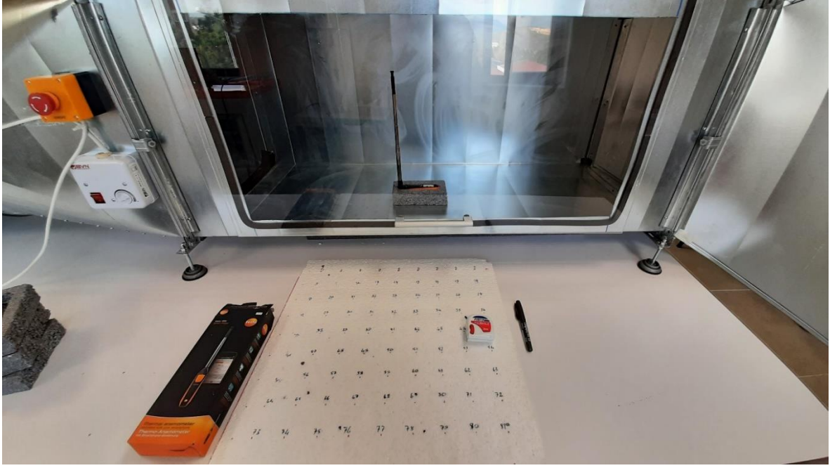
Şekil 5.2. Anemometre ile hız ölçümü alınması
