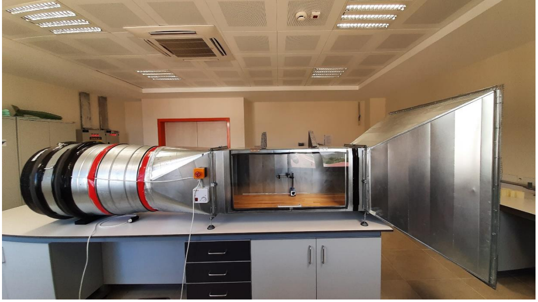
Şekil 3.6. İmalatı yapılan rüzgar tüneli
