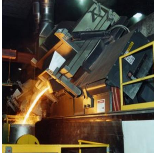
Şekil 4.5 Sıvı metalin indüksiyon ocağında tretmana aktarımı
