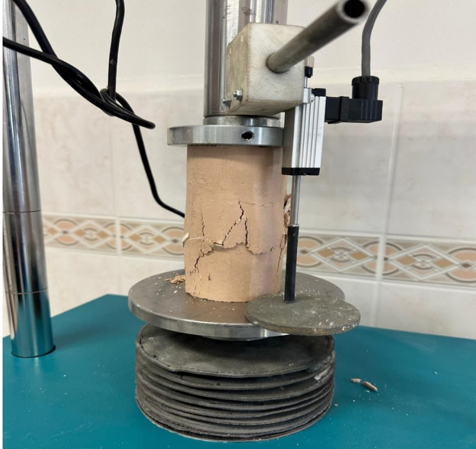
Şekil 4. 13. Serbest basınç deneyinde Yük dayanım Belirlenmesi
