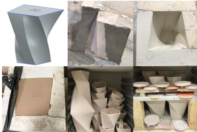
Görsel 4. 1. NX Siemens Programında Modelleme, Alçı Kalıplama İşlemi, Döküm Yöntemi ile Şekillendirme, Bisküvi Pişirimi (950 °C) ve Sırlı Pişirim Aşaması (1050-1100 ve 1200 °C).
