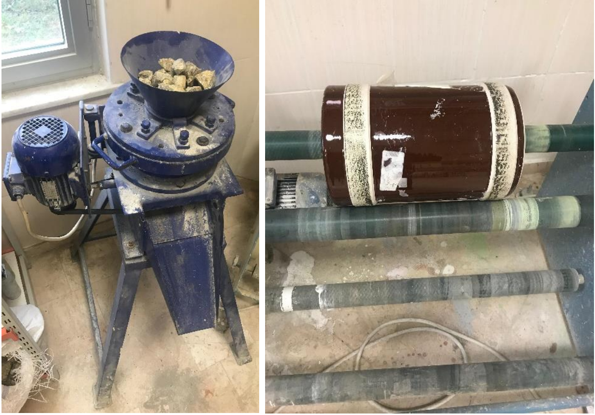
Görsel 2.7. Bozüyük Bölgesi Granit ve Feldspat Hammaddelerinin Konik Kırıcıda Ön Kırma İşlemi ve Bilyeli Değirmende Kuru Öğütme İşlemi.
