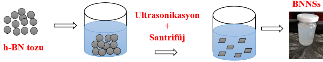
Şekil 3.1. Bor nitrür nanotabaka (BNNSs) sentezi
