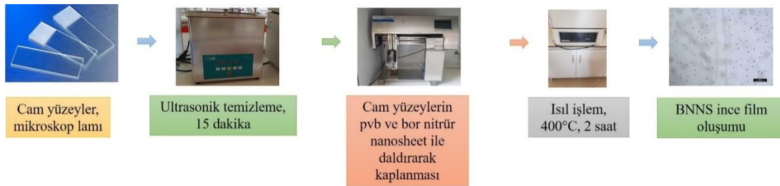
Şekil 3.2. Bor nitrür nanotabaka ince film oluşumu
