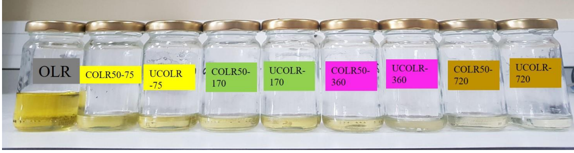
Şekil 4.25. Farklı UV bozunma sürelerinde 50 kez BNNs kaplamalı ve kaplamasız cam şişelerin içerisindeki riviera zeytinyağlarının renk görselleri
