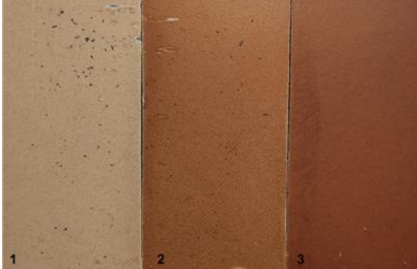
Resim 3.79. Tabletlerin fırın çıkışı görselleri-55 (1) 1gr Kahverengi pigment +Mat sır, (2) 3gr Kahverengi pigment + mat sır, (3) 5gr Kahverengi pigment + mat sır.(Cihan Yavaş Görsel Galerisi)
