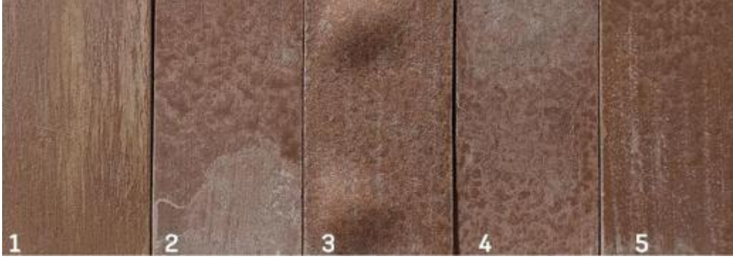
Resim 3.62. 2 gr bej rengi pigment ile hazırlanan çözeltilerin uygulandığı tabletler. (1) 5ml Su + 2gr Bej Pigment, (2) 5ml Benzin +2gr Bej Pigment, (3) 5ml Mazot + 2gr Bej Pigment, (4) 5ml Selülozik tiner + 2gr Bej Pigment, (5) 5ml Sentetik tiner + 2gr Bej Pigment.(Cihan Yavaş Görsel Galerisi)
