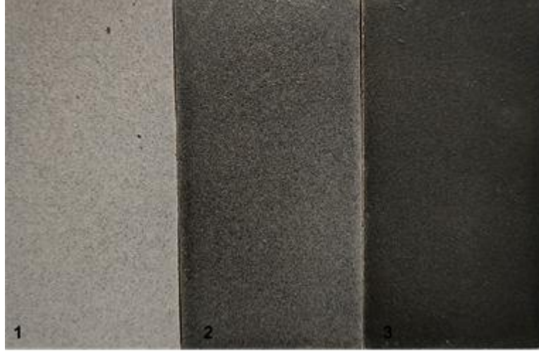
Resim 3.76. Tabletlerin fırın çıkışı görselleri-52 (1) 1gr Siyah pigment +parlak sır, (2) 3gr Siyah pigment + parlak sır, (3) 5gr Siyah pigment + parlak sır.(Cihan Yavaş Görsel Galerisi)
