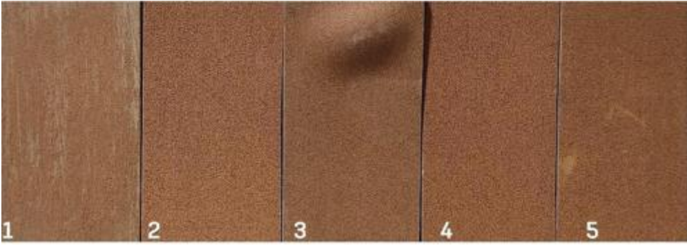
Resim 3.50. 2 gr bej rengi pigment ile hazırlanan çözeltilerin uygulandığı tabletler. (1) 5ml Su + 2gr Bej Pigment, (2) 5ml Benzin +2gr Bej Pigment, (3) 5ml Mazot + 2gr Bej Pigment, (4) 5ml Selülozik tiner + 2gr Bej Pigment, (5) 5ml Sentetik tiner + 2gr Bej Pigment, (Cihan Yavaş Görsel Galerisi)
