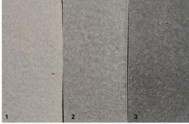
Resim 3.84. Tabletlerin fırın çıkışı görselleri-60 (1) 1gr Siyah pigment +şugar sır, (2) 3gr Siyah pigment + şugar sır, (3) 5gr Siyah pigment + şugar sır.(Cihan Yavaş Görsel Galerisi)
