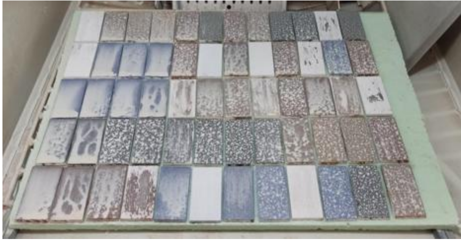
Resim 3.19. Tabletlerin sırlanması (Cihan Yavaş Görsel Galerisi)
