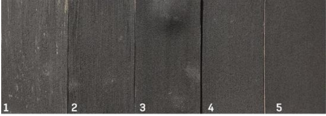
Resim 3.58. 6 gr siyah pigment ile hazırlanan çözeltilerin uygulandığı tabletler. (1) 5ml Su + 6gr Siyah Pigment, (2) 5ml Benzin +6gr Siyah Pigment, (3) 5ml Mazot + 6gr Siyah Pigment, (4) 5ml Selülozik tiner + 6gr Siyah Pigment, (5) 5ml Sentetik tiner + 6gr Siyah Pigment. (Cihan Yavaş Görsel Galerisi)
