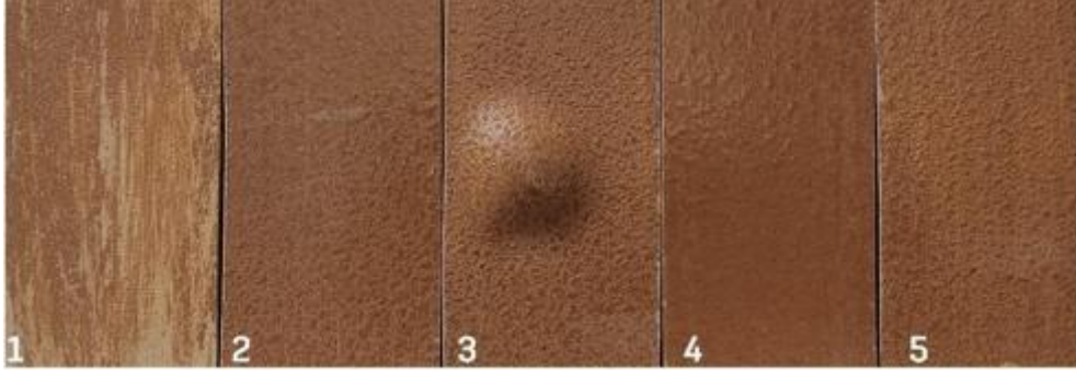
Resim 3.38. 2 gr bej rengi pigment ile hazırlanan çözeltilerin uygulandığı tabletler. (1) 5ml Su + 2gr Bej Pigment, (2) 5ml Benzin +2gr Bej Pigment, (3) 5ml Mazot + 2gr Bej Pigment, (4) 5ml Selülozik tiner + 2gr Bej Pigment, (5) 5ml Sentetik tiner + 2gr Bej Pigment, (Cihan Yavaş Görsel Galerisi)
