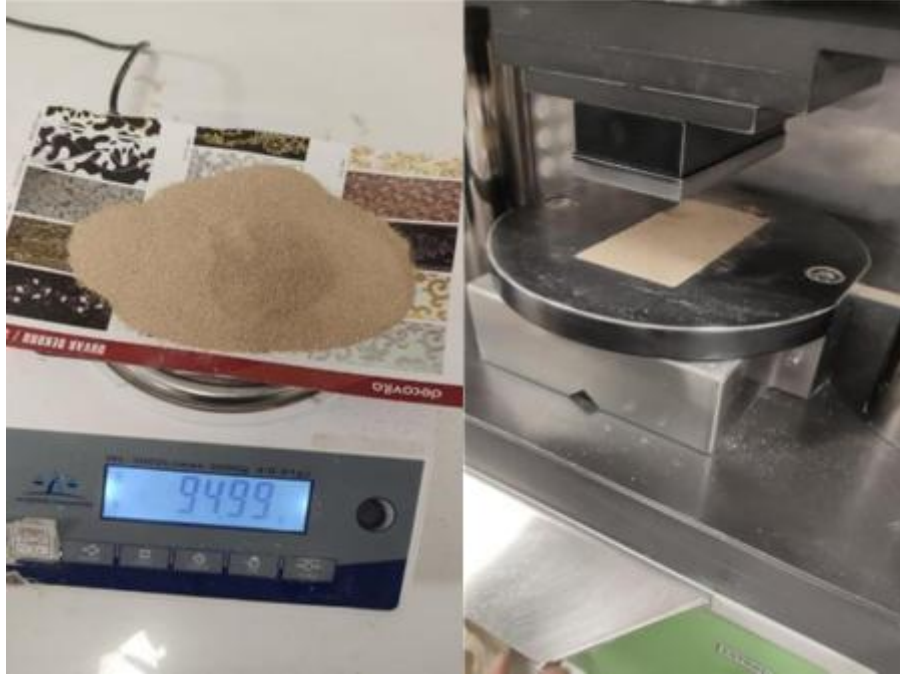
Resim 3.4. Toz granül ölçümü (Cihan Yavaş Görsel Galerisi)
