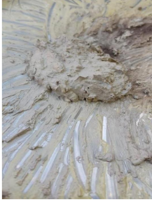
Resim 3.2. Solvent maddesinin boya içerisinde yüksek oranda buharlaşmış görünümü (Cihan Yavaş Görsel Galerisi)
