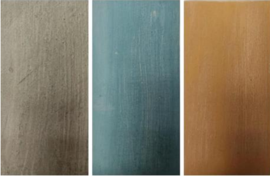
Resim 3.13. Su ve pigment karışımı (Soldan sağa renkler: Siyah, Mavi, Bej) (Cihan Yavaş Görsel Galerisi)
