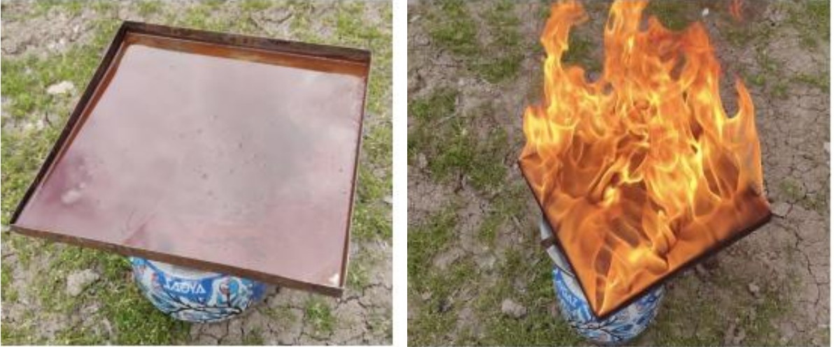
Resim 3.1. Kahverengi atık boyanın çelik tepside ısı işlemine tabi tutulması ve ısı verilen solvent bazlı dijital baskı boyasının alev alması (Cihan Yavaş Görsel Galerisi)
