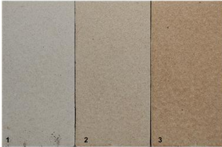
Resim 3.81. Tabletlerin fırın çıkışı görselleri-57 (1) 1gr Bej pigment +şugar sır, (2) 3gr Bej pigment + şugar sır, (3) 5gr Bej pigment + şugar sır.(Cihan Yavaş Görsel Galerisi)
