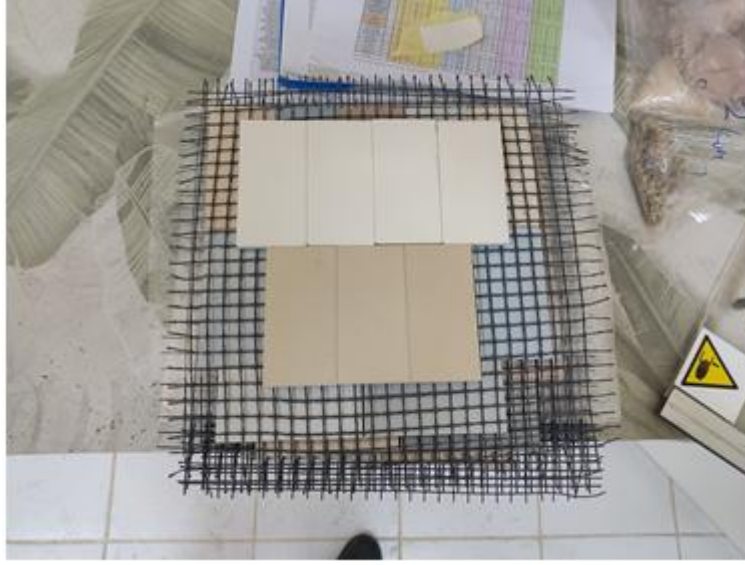
Resim 3.72. Deneme tabletlerinin pişirim öncesi fırın tellerine dizim işlemi (Cihan Yavaş Görsel Galerisi)
