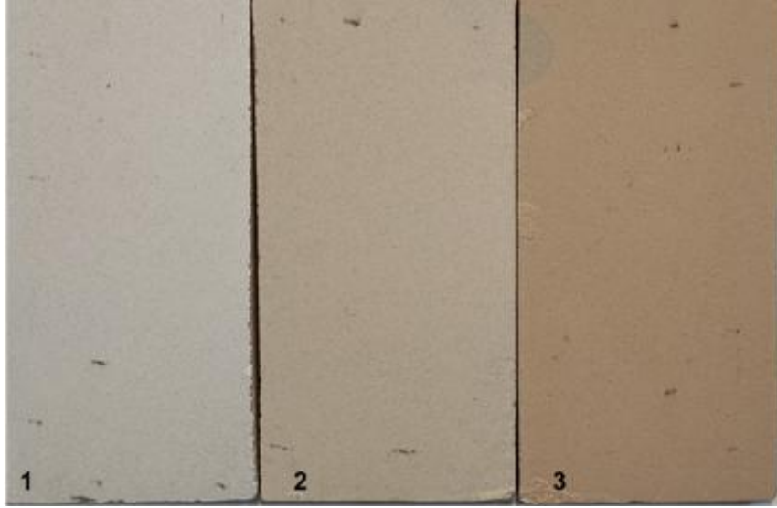
Resim 3.87. Tabletlerin fırın çıkışı görselleri-63 (1) 1gr kahverengi pigment +engob, (2) 3gr Kahverengi + engob, (3) 5gr Kahverengi pigment + engob. (Cihan Yavaş Görsel Galerisi)
