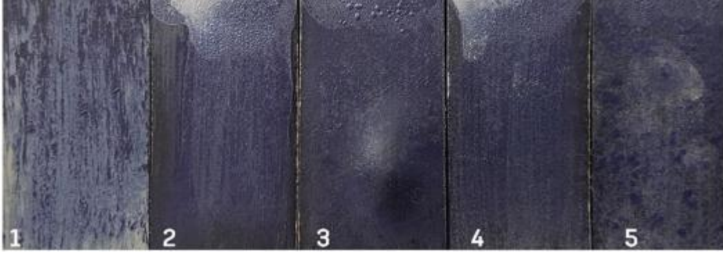
Resim 3.65. 2 gr mavi rengi pigment ile hazırlanan çözeltilerin uygulandığı tabletler. (1) 5ml Su + 2gr Mavi Pigment, (2) 5ml Benzin +2gr Mavi Pigment, (3) 5ml Mazot + 2gr Mavi Pigment, (4) 5ml Selülozik tiner + 2gr Mavi Pigment, (5) 5ml Sentetik tiner + 2gr Mavi Pigment.(Cihan Yavaş Görsel Galerisi)
