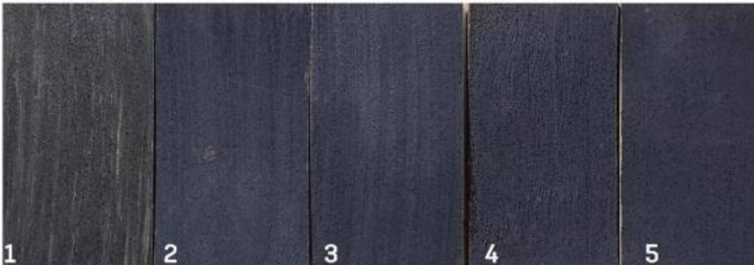
Resim 3.54. 4 gr mavi pigment ile hazırlanan çözeltilerin uygulandığı tabletler. (1) 5ml Su + 4gr Mavi Pigment, (2) 5ml Benzin +4gr Mavi Pigment, (3) 5ml Mazot + 4gr Mavi Pigment, (4) 5ml Selülozik tiner + 4gr Mavi Pigment, (5) 5ml Sentetik tiner + 4gr Mavi Pigment (Cihan Yavaş Görsel Galerisi)
