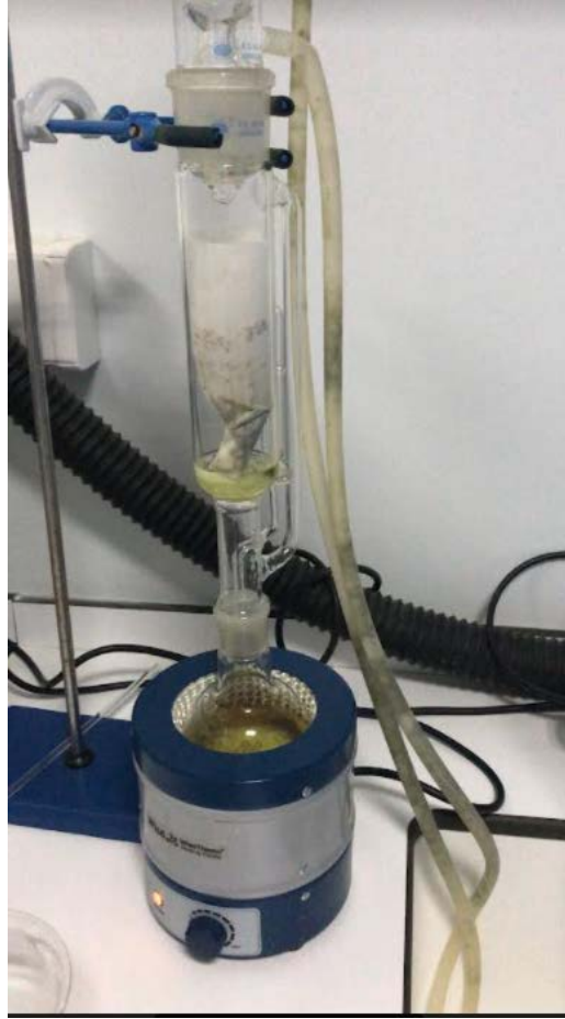
Şekil 3.1. Ekstraksiyonu yapılan bitkilerin soxhlet cihazındaki görüntüsü
