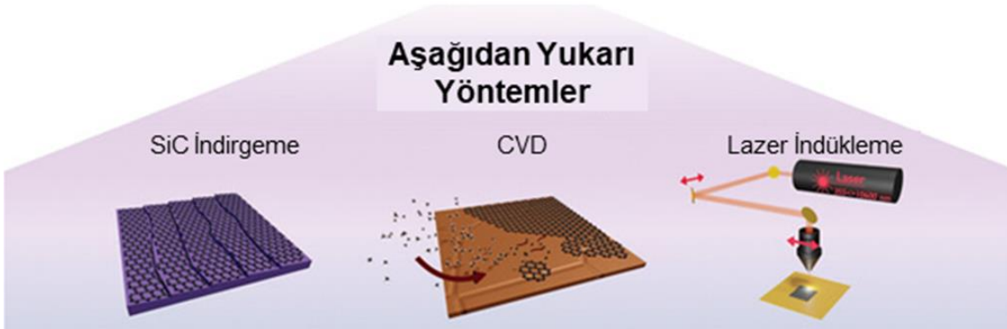
Şekil 2.6. A) Grafen sentez yöntemlerinin şematik çizelgesi ve B) Aşağıdan yukarı ve yukarıdan aşağı grafen üretim yöntemlerine dair üretim akışları.
