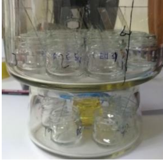
Şekil 6.14. GO yüzeylerin HI buharına maruz bırakılması ile grafene indirgenme işleminin gerçekleştirildiği desikatörün dijital fotoğrafı.
