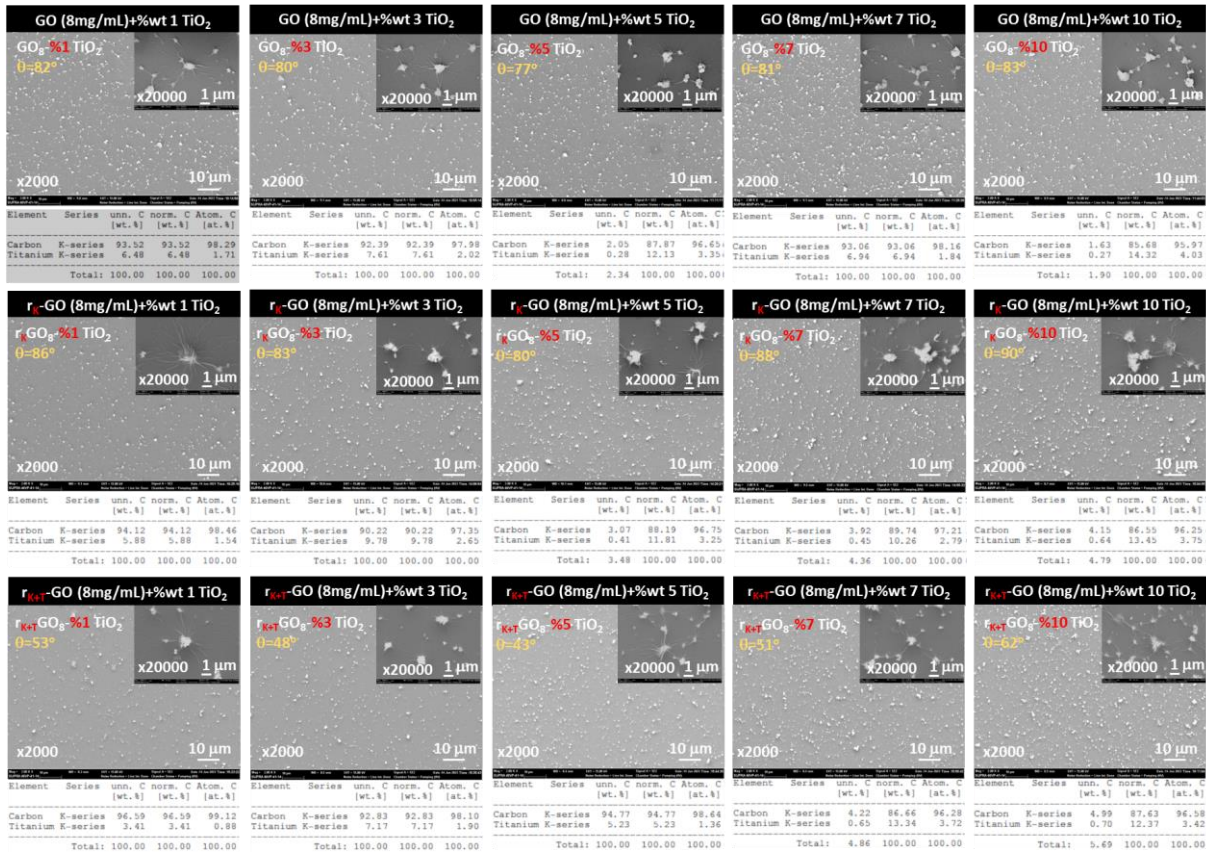
Şekil 6.26. 8mg/mL konsantrasyonlu GO dispersiyonuna farklı bileşimlerde TiO 2 katkılanmasıyla elde edilen GO-TiO 2 dispersiyonlarından daldırarak kaplama yöntemi kaplanmış GO-TiO 2 yüzeylerine ve bu yüzeylerin kimyasal (rK-GO-TiO 2 ) ve kimyasal+termal indirgenme ile üretilen (rK+T-GO-TiO 2 ) yüzeylerine ait SEM, SEM-EDX ve temas açısı ölçüm sonuçları.
