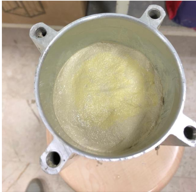
Resim 3.4. Çamurun Tank İçerisine Yerleştirilmesi
