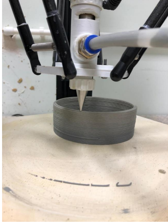
Resim 3.39. Üç Boyutlu Yazıcıyla Üretim Aşaması, FDM Yöntemi
