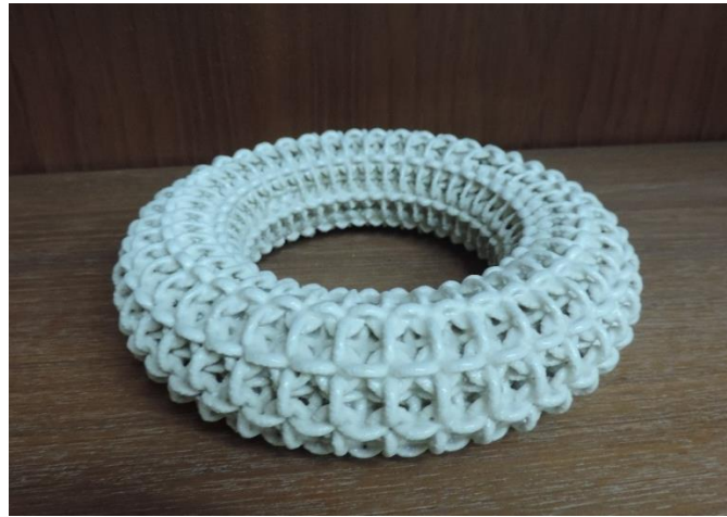
Resim 2.19. Tethon 3D Toz Bağlama Yöntemiyle Şekillendirilmiş Form, 11x21x21 Cm Kaynak: (Can, 2016)
