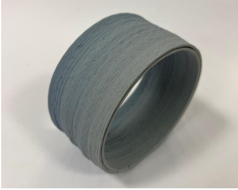
Resim 3.51. Kobalt Yankısı, Üç Boyutlu Yazıcı İle Şekillendirme, Kobalt Oksit Katkılı Porselen Çamuru, 3 mm Nozzle Uç, 1200°C
