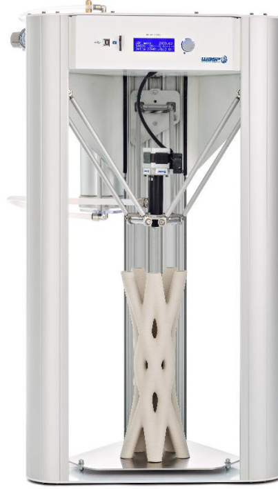
Resim 2.17. Delta Tipi Yazıcı Wasp
