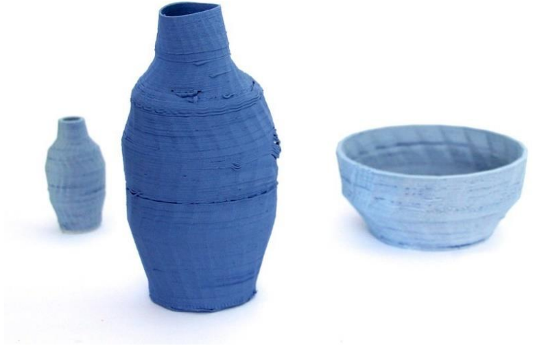
Resim 2.32. Üç Boyutlu Yazıcıda Şekillendirilmiş Renkli Porselen Baskı Kaynak: (Unfold.Be, 2012)
