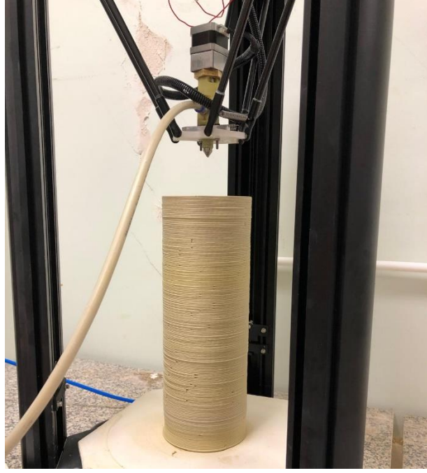
Resim 3.11. Üç Boyutlu Yazıcıyla Üretim Aşaması, FDM Yöntemi
