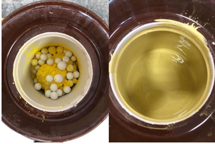
Resim 3.1. Renklendirilmiş Çamurun Hazırlık Aşaması
