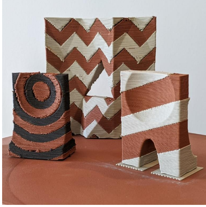
Resim 2.31. Üç Boyutlu Seramik Yazıcı İle Şekillendirilmiş Renkli Form
