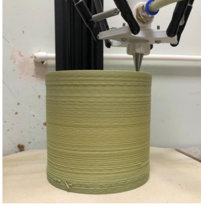
Resim 3.21. Üç Boyutlu Yazıcıyla Üretim Aşaması, FDM Yöntemi
