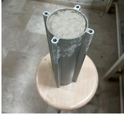
Resim 3.5. Çamurun Tank İçerisine Yerleştirilmesi
