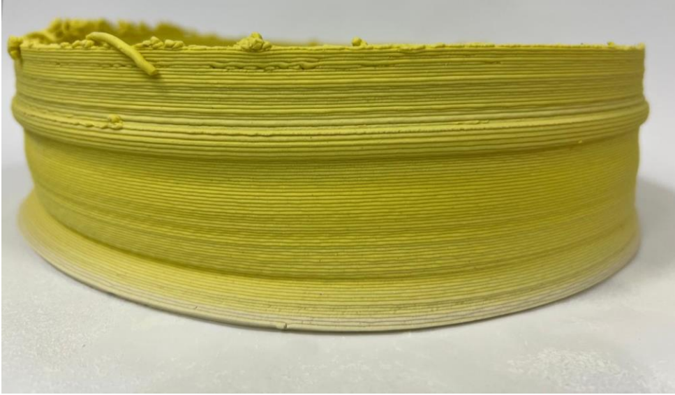
Resim 3.18. Rüya, Üç Boyutlu Yazıcı İle Şekillendirme, Sarı Pigment Katkılı Porselen Çamuru, 2 mm Nozzle Uç, 1200°C
