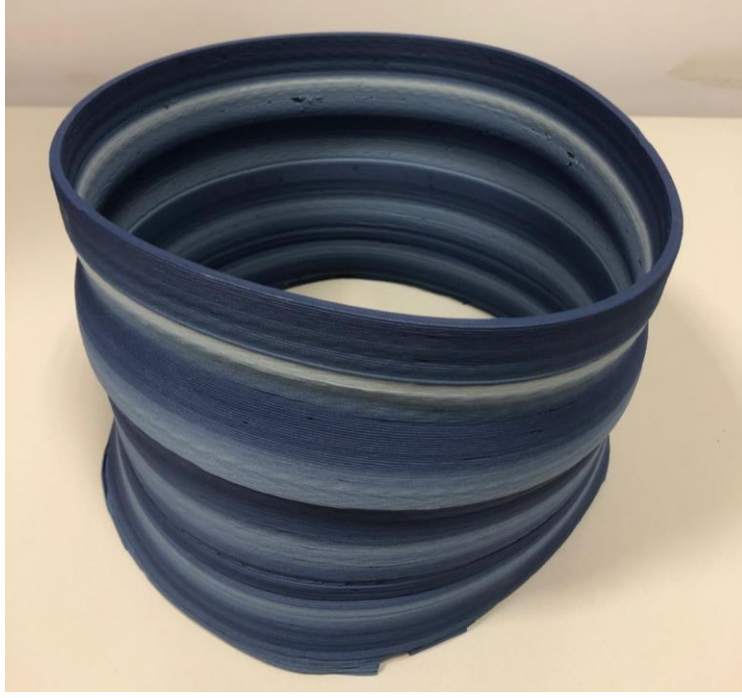
Resim 3.56. Kobalt Yankısı, Üç Boyutlu Yazıcı İle Şekillendirme, Kobalt Oksit Katkılı Porselen Çamuru, 2 mm Nozzle Uç, 1200°C
