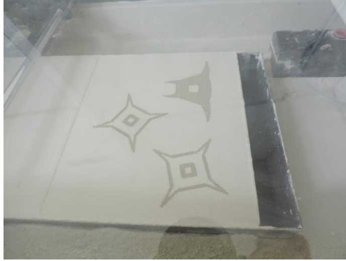
Resim 2.18. Toz Bağlama Yöntemiyle Şekillendirme Aşaması, Zcorp Makine Kaynak: (Can, 2016)
