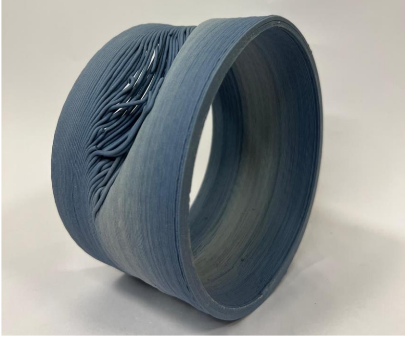
Resim 3.53. Kobalt Yankısı, Üç Boyutlu Yazıcı İle Şekillendirme, Kobalt Oksit Katkılı Porselen Çamuru, 3 mm Nozzle Uç, 1200°C
