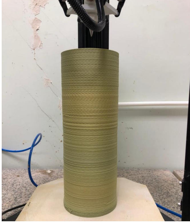
Resim 3.22. Üç Boyutlu Yazıcıyla Üretim Aşaması, FDM Yöntemi
