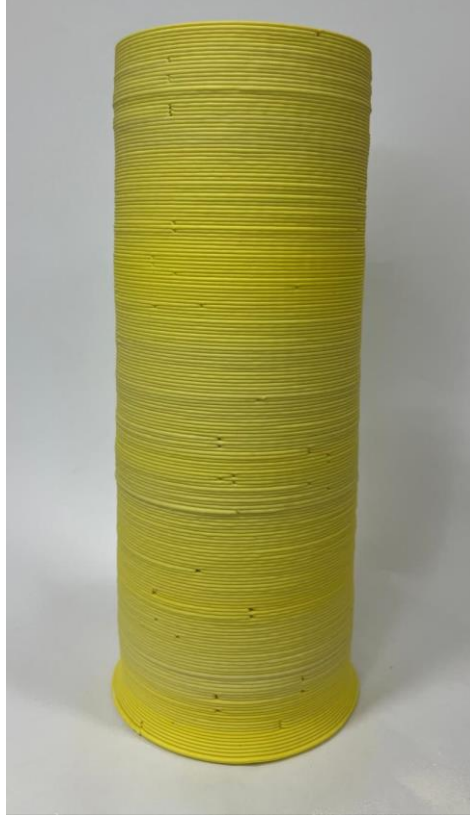
Resim 3.16. Rüya, Üç Boyutlu Yazıcı İle Şekillendirme, Sarı Pigment Katkılı Porselen Çamuru, 2 mm Nozzle Uç, 1200°C
