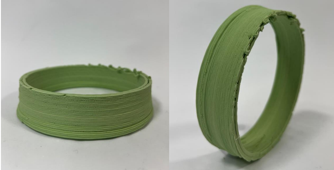
Resim 3.33. Toprağın Yeşili, Üç Boyutlu Yazıcı İle Şekillendirme, Yeşil Pigment Katkılı Porselen Çamuru, 3 mm Nozzle Uç, 1200°C
