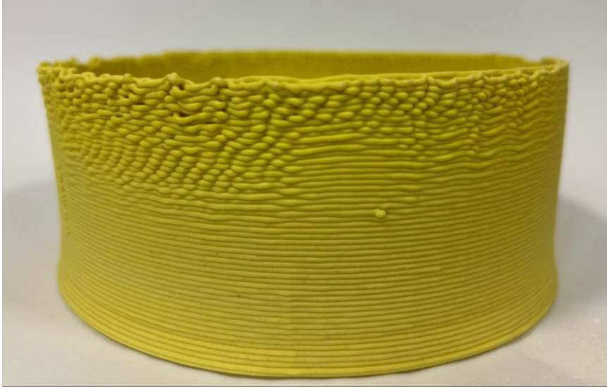
Resim 3.17. Rüya, Üç Boyutlu Yazıcı İle Şekillendirme, Sarı Pigment Katkılı Porselen Çamuru, 2 mm Nozzle Uç, 1200°C
