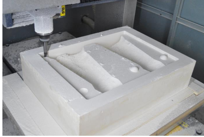
Resim 2.2. CNC İle Alçı Kalıp Üretim Süreci
