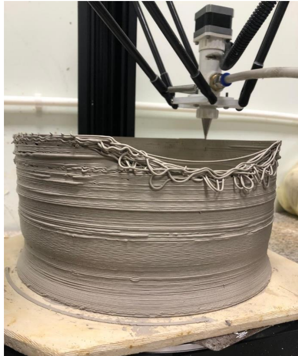
Resim 3.38. Üç Boyutlu Yazıcıyla Üretim Aşaması, FDM Yöntemi
