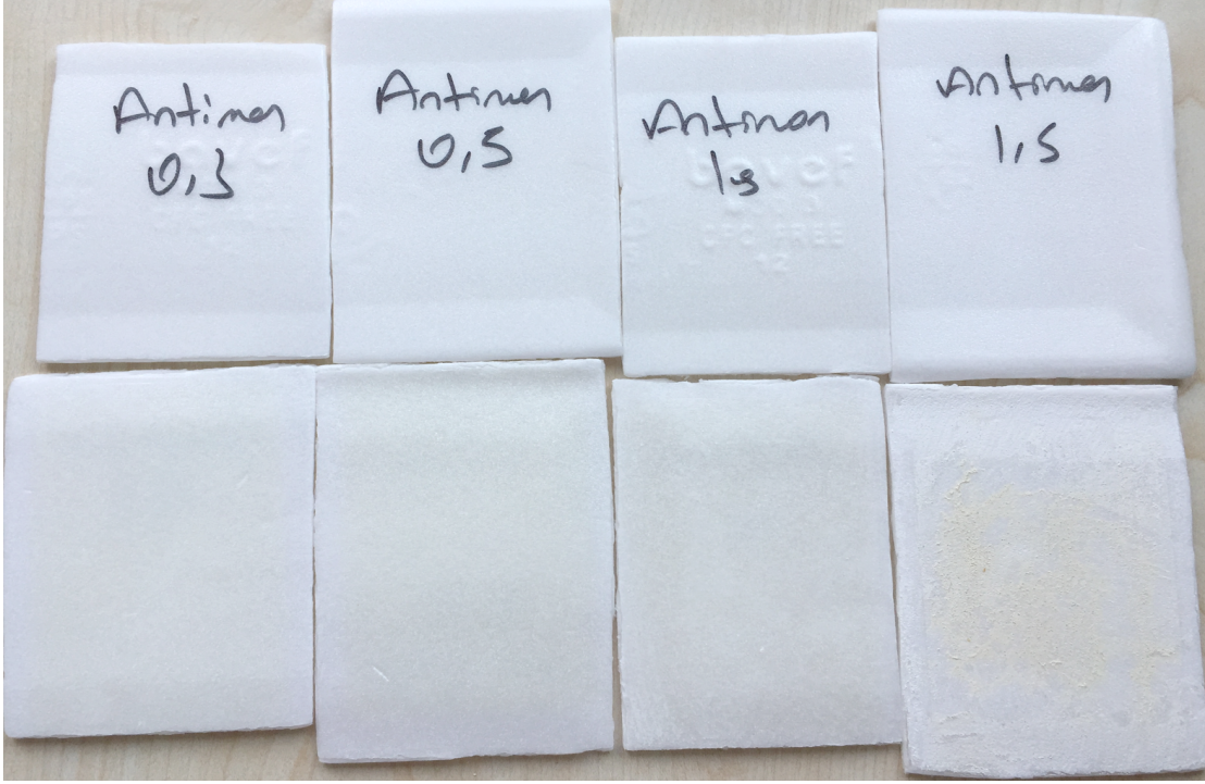
Şekil.9 Antimon klorür kaplanmış PS plakaların görünümleri
