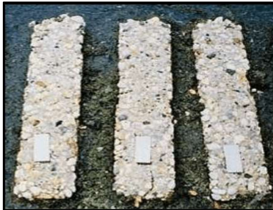
Şekil 3.6. Sülfat saldırısına uğramış normal dayanımlı beton (Yazıcı, 2014).
