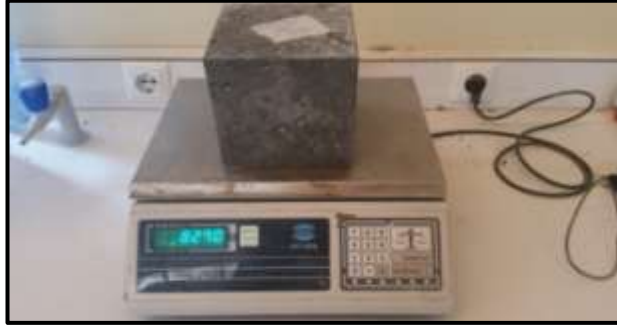
Şekil 4.8. Numune Ağırlığının ölçülmesi.
