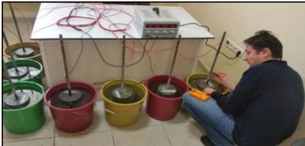
Şekil 4.14. Hızlandırılmış korozyon deney düzeneği.
