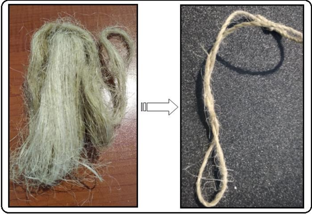
Resim 24: Kenevir lifinin ip haline getirilmesi
