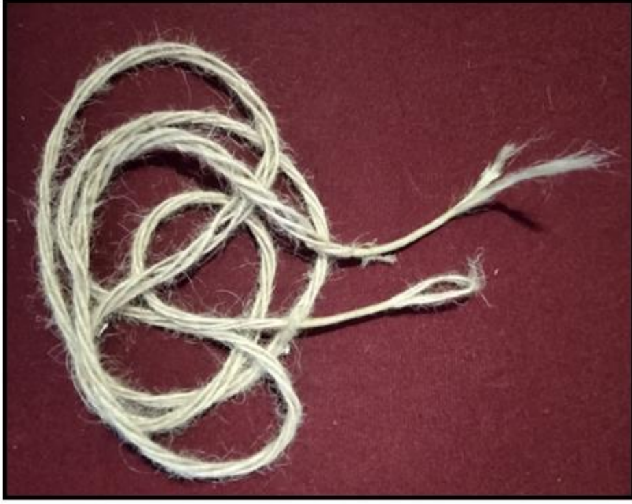
Resim 25: Yay çekiliş denemesinde kopan kiriş ipi
