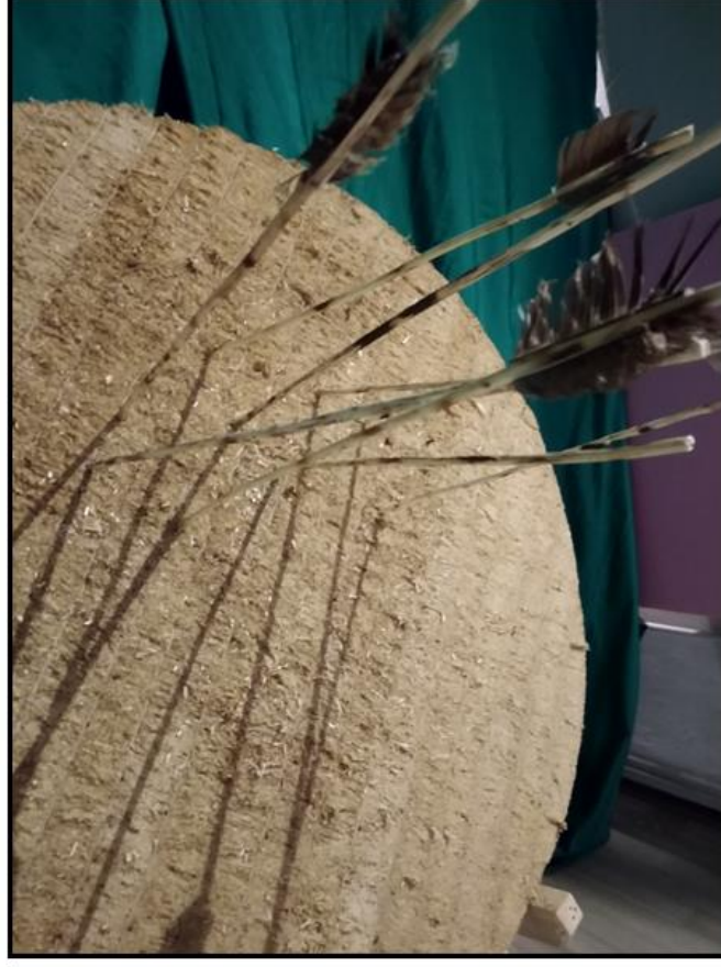
Resim 50: Fındık ağacı kullanılarak yapılan 27 lbs yay ile 20 m atış sonuçları
