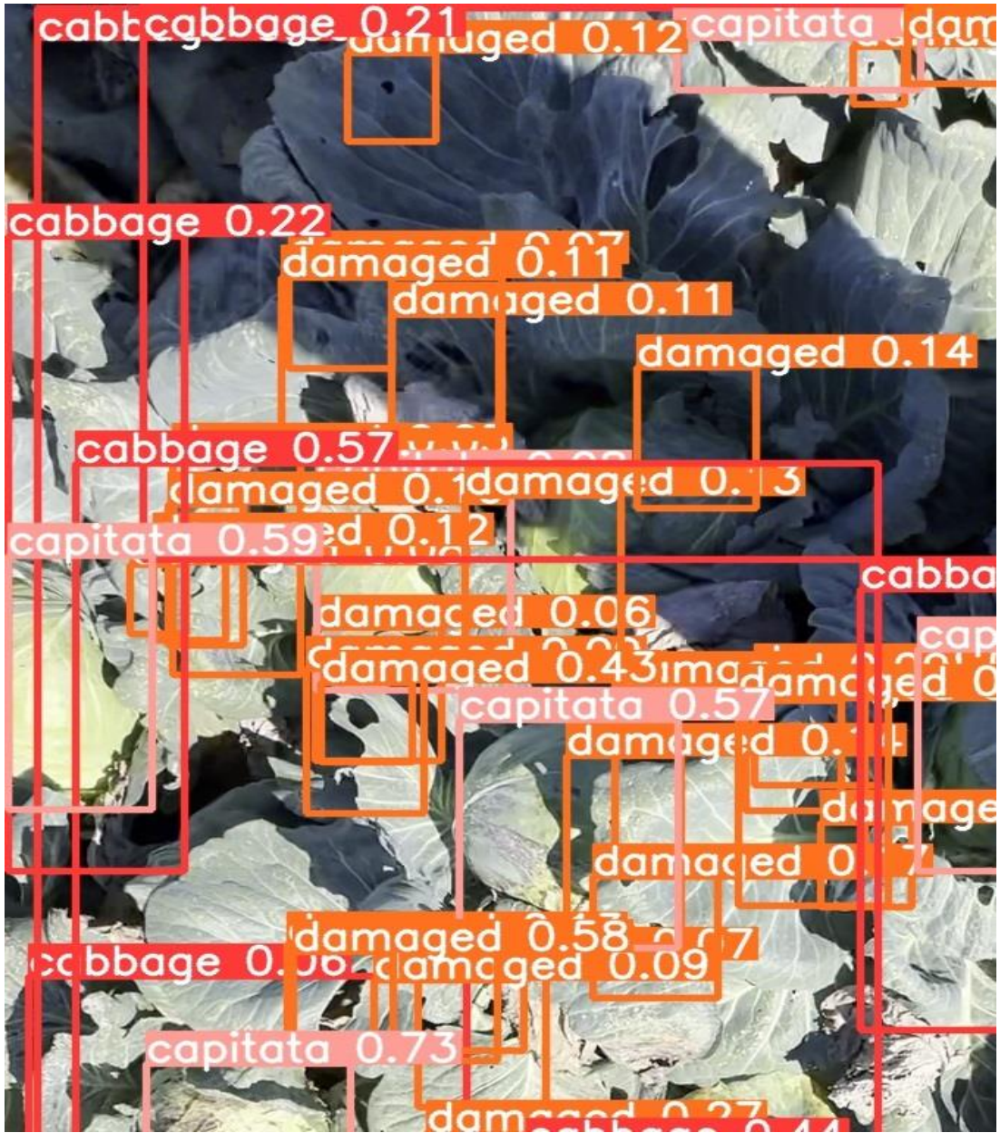
Şekil 4.11. %11,2 Hasar oranlı test resmi etiketleri
