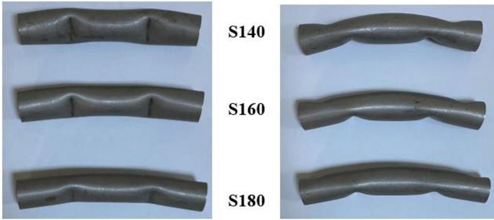
Şekil 4.7. Dört nokta test düzeneğinde farklı destek aralıklarında deforme olmuş daire kesitli numuneler
