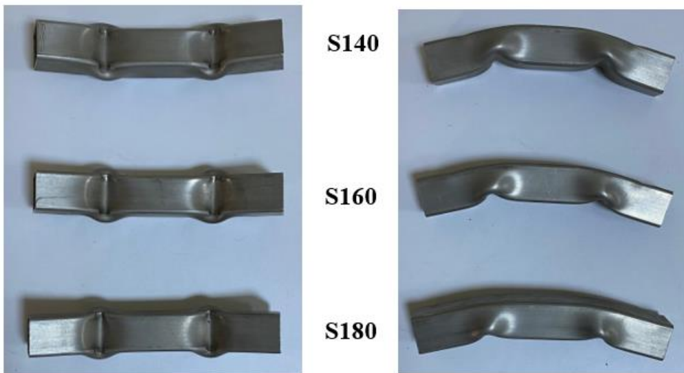
Şekil 4.8. Dört nokta test düzeneğinde farklı destek aralıklarında deforme olmuş kare kesitli numuneler
