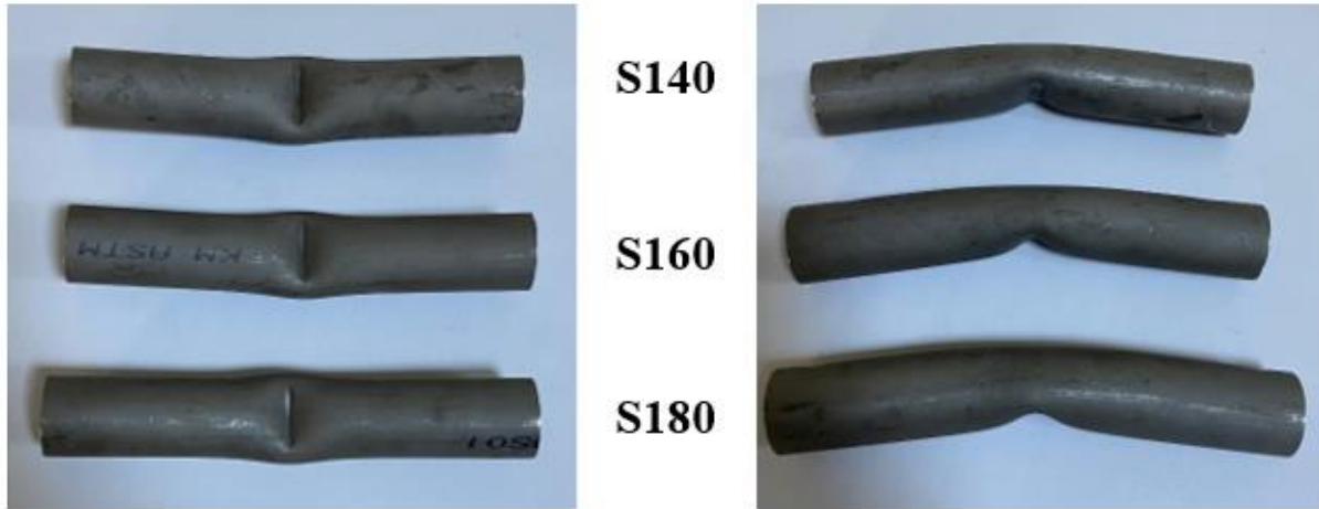
Şekil 4.5. Üç nokta test düzeneğinde farklı destek aralıklarında deforme olmuş daire kesitli numuneler
