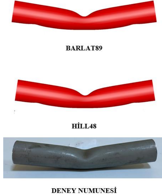
Şekil 4.29. S140 mesnet aralığında deforme olmuş daire kesitli profillerin karşılaştırılması
