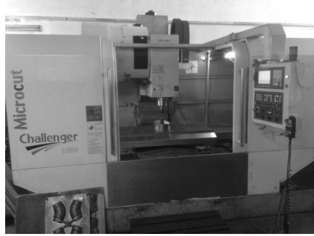
Şekil 12. Microcut 1000 CNC dik işleme (solda), iş parçası ve kesici takım bağlantı şekli (sağda)
