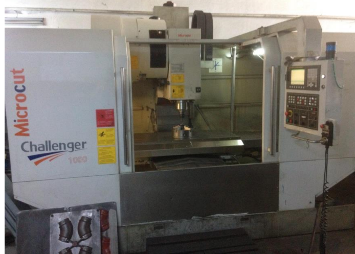
Şekil 3 Microcut 1000 CNC dik işleme (solda), iş parçası ve kesici takım bağlantı şekli (sağda)
