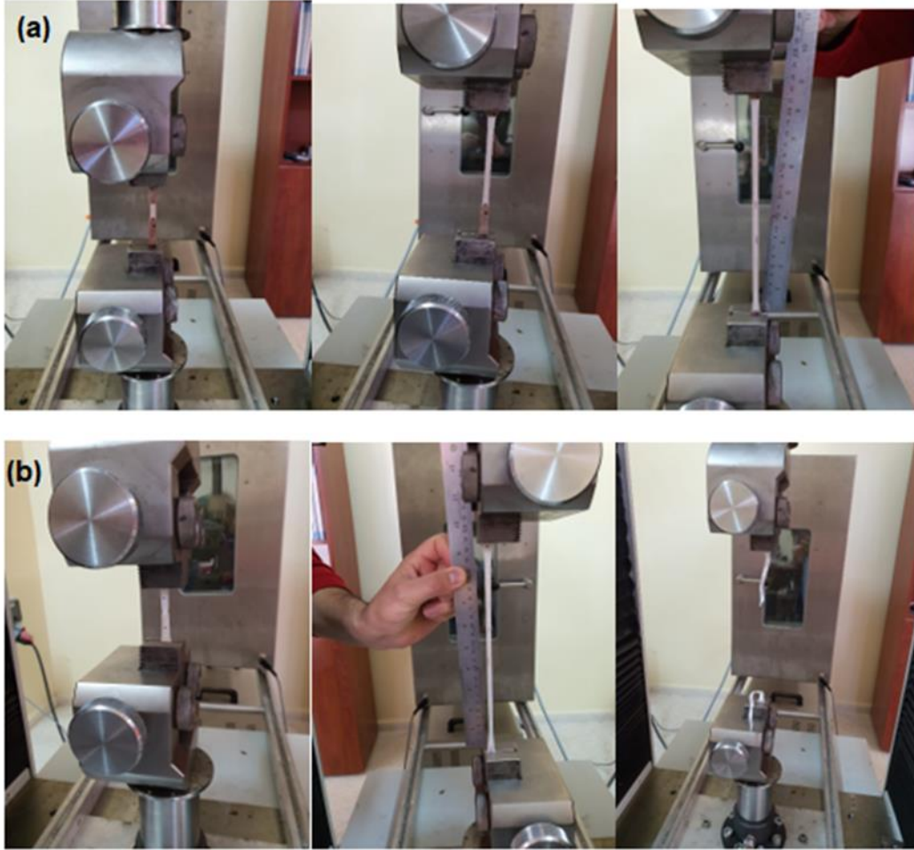
Şekil 6.4. (a) PCL/KCQDs nanokompozit ve (b) PCL filmlerin çekme testi
