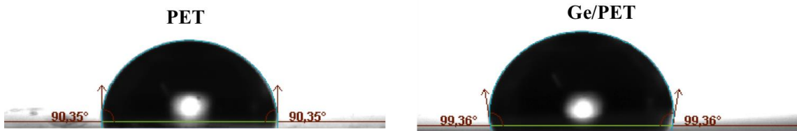
Şekil 7: Germanyum kaplanmış ve kaplanmamış PET numunesinin temas açıları
