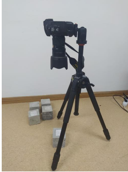
Şekil 4.4. Numune Görüntülerini Elde Etmek İçin Hazırlanan Düzenek
