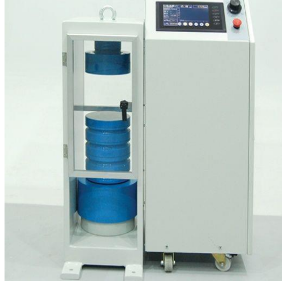
Şekil 4.6. Beton Basınç Test Cihazı
