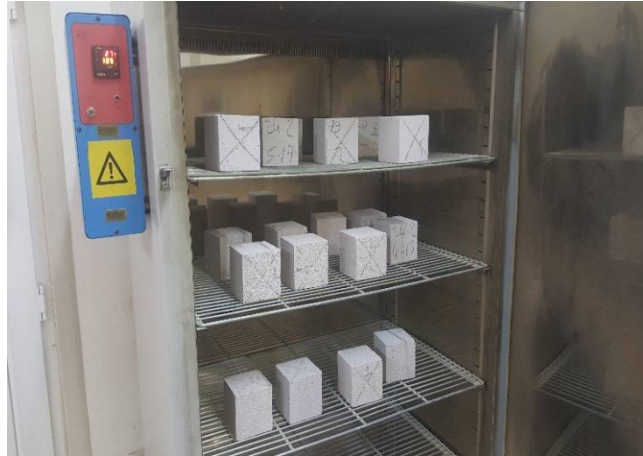
Şekil 3.5. Etüvde kurutulan numuneler.
