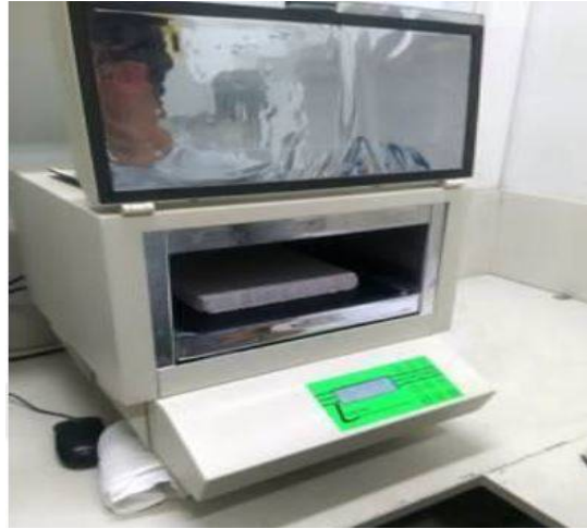
Şekil 3.6. Isıl iletkenlik ölçüm cihazı.
