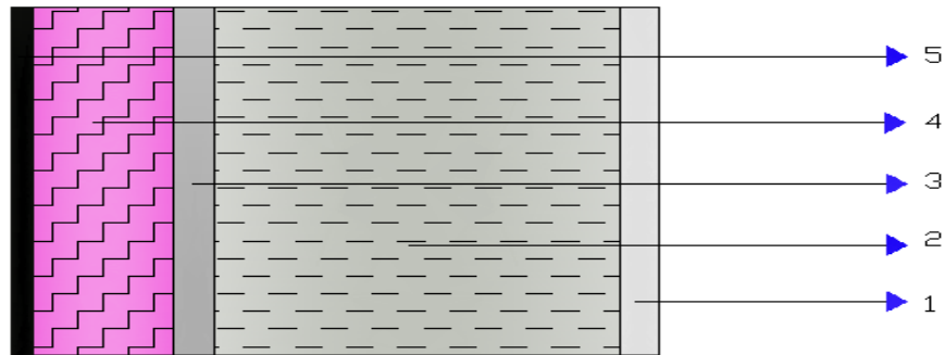
Şekil 8.3. Toprak temaslı duvar (betonarme) detayı.
