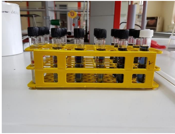
Şekil 3.8. Toplam fenol analizi için hazırlanan kalibrasyon çözeltileri.
