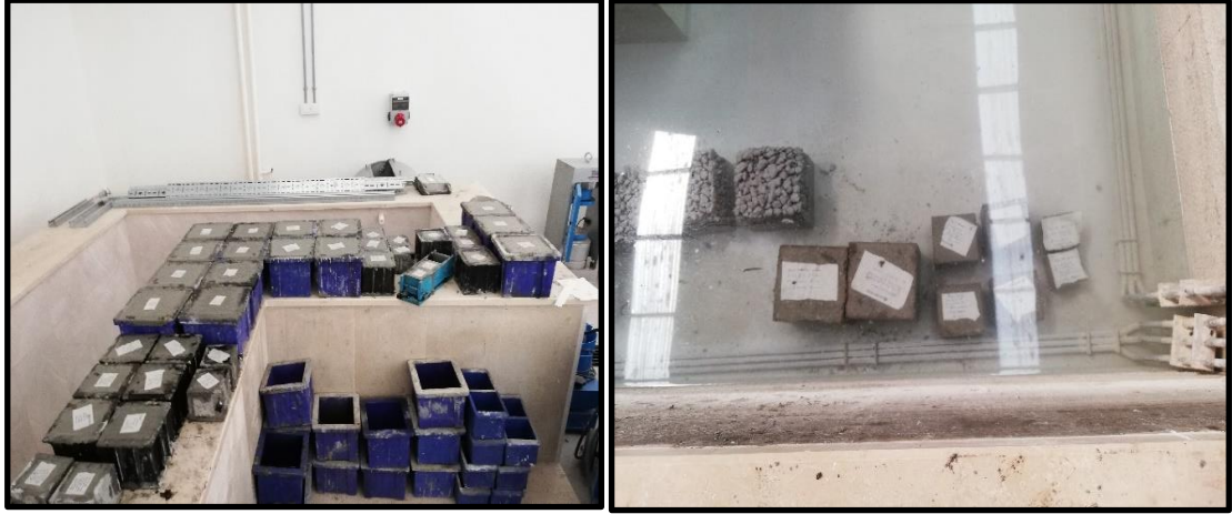
Şekil 3.4. Hazırlanan beton karışımlarının kalıptan sökülüp kür havuzunda bekletilmesi.
