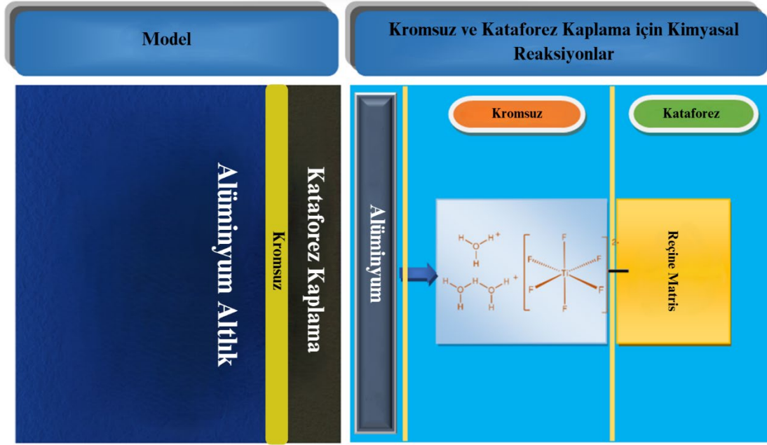
Şekil 8.2. Alüminyum, kromsuz ve kataforez kaplamanın kesit modeli.
