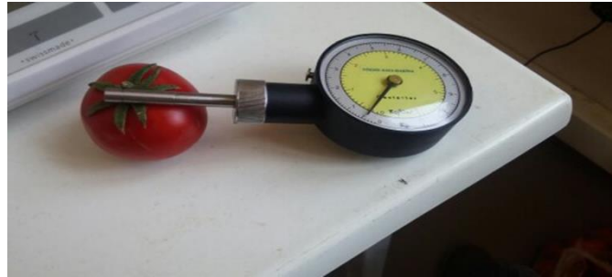
Şekil 3.12. El penetrometresi ile meyve eti sertliğinin belirlenmesi
