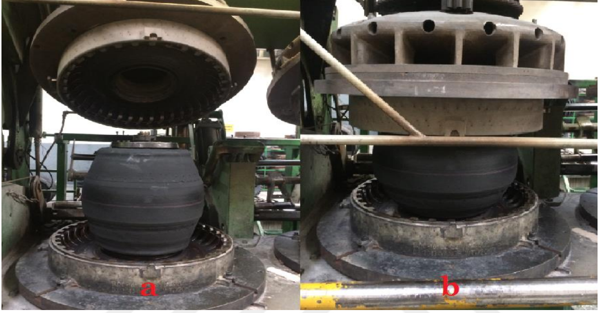
Şekil 2.6. a) Pres kapatılmaya başlandığındaki ön şekillendirme b) Pres kapanmaya yakın ön şekillendirme
