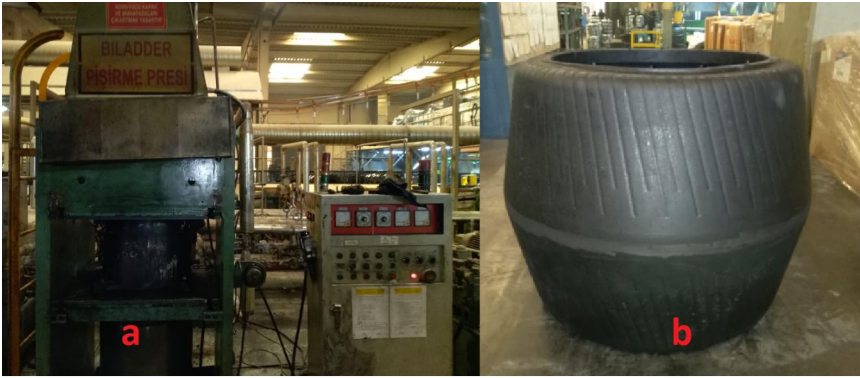
Şekil 2.3. a) Pişirme torbası presi b) Pişirme torbası
