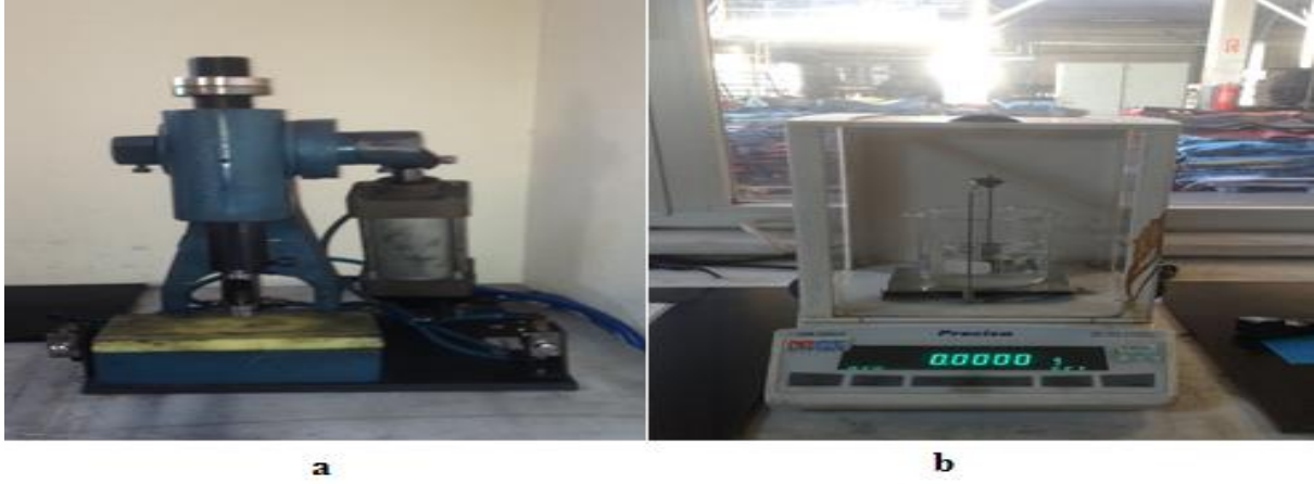
Şekil 4.7. a) Numune alma ekipmanı b) Yoğunluk test cihazı
