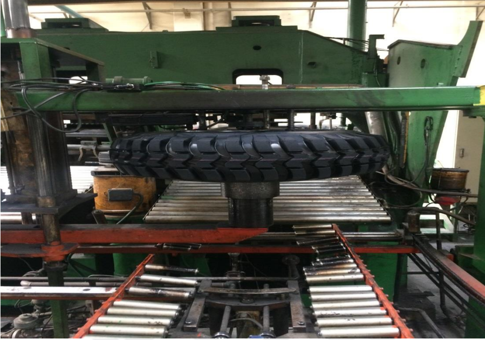
Şekil 2.8. Soğutma ünitesine bağlanan kürlenmiş lastik
