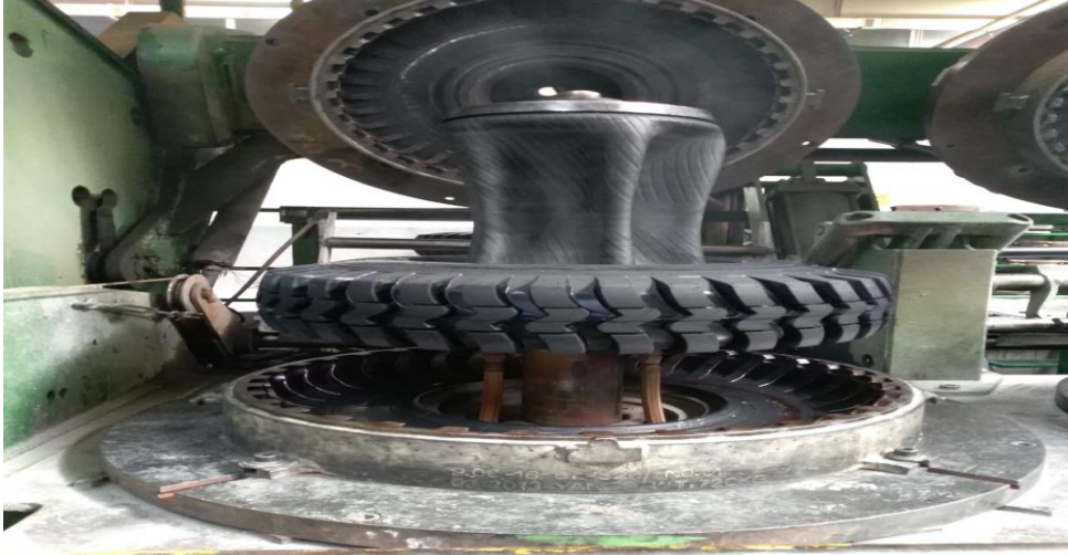
Şekil 2.7. Kendini vakumlamış pişirme torbası ve kürlenmiş lastik
