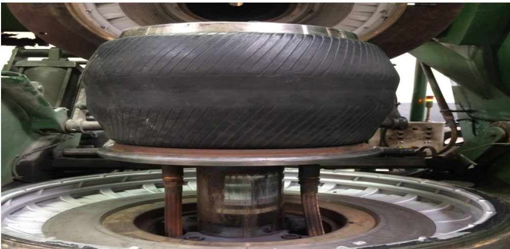
Şekil 2.4. Mile bağlantı halkaları ile bağlanmış pişirme torbası
