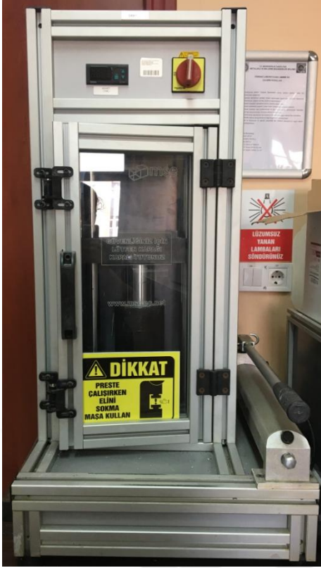
Şekil 4.5. Kullanılan tek eksenli hidrolik pres ve kalıplar
