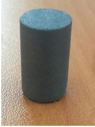
Şekil 5.8. Üretilen Fe-Mn-Si-Mg-C (Ni eşdeğeri % 20 -Cr eşdeğeri % 10) alaşımının fotoğrafı
