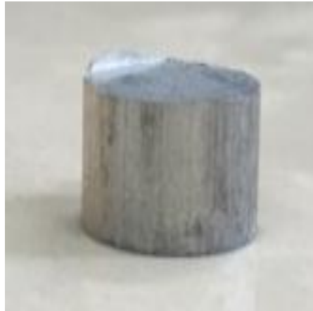
Şekil 5.7. Zn-Mg-Cu-Ta alaışımının sinterleme sonrası fotoğrafı
