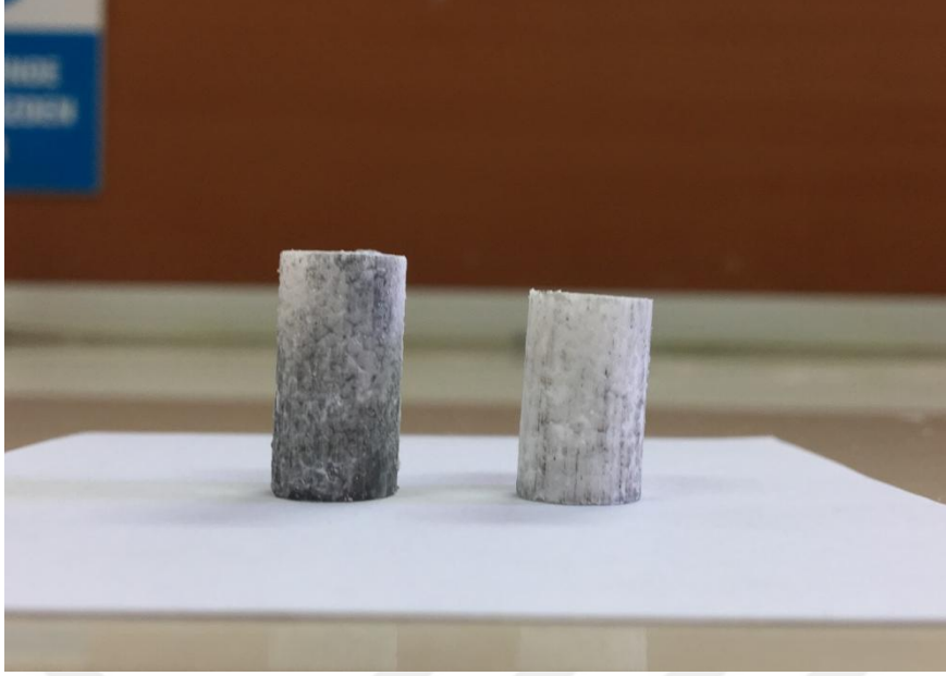
Şekil 5.5. Sinterlenmemiş gözenekli TCP numunelerinin fotoğrafı
