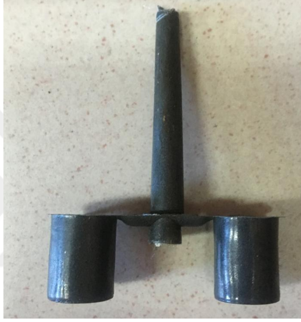
Şekil 5.12. Toz enjeksiyon kalıplama yöntemi ile üretilmiş Fe numunesi
