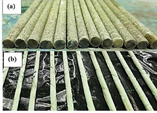
Şekil 3. (a) Kumla kaplı GFRP donatısı (b) Nervürlü GFRP donatısı [25]
