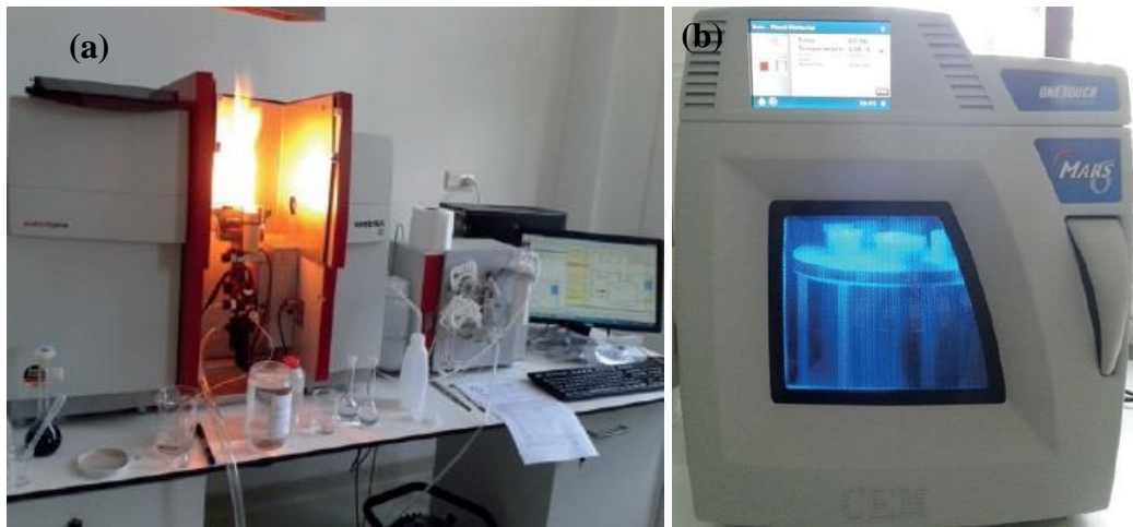
Şekil 3.5. Çalışmada kullanılan atomik absorpsiyon spektrometresi (AAS) a) Analitik Jena-ContraAA 300 ve b) CEM-Mars 6 cihazları.
