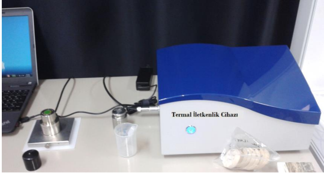
Şekil 3.10. Çalışmada kullanılan C-Therm marka termal analiz cihazı.
